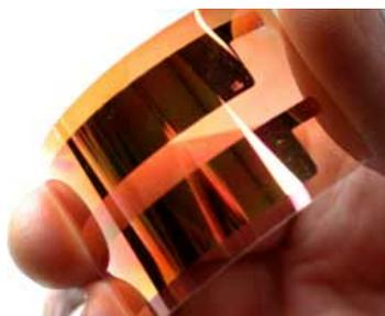
*Abbildung 13: Bild einer flexiblen, organischen Solarzelle.*
