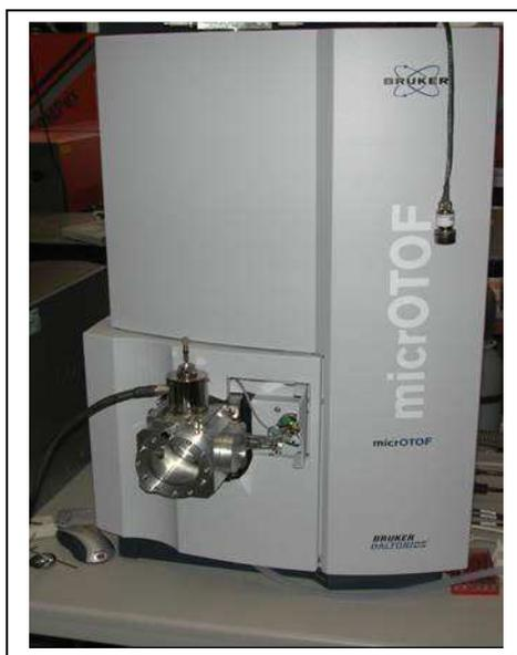
Abbildung 12: micrOTOF mit neu entwickelter LC-APLI-Quelle
