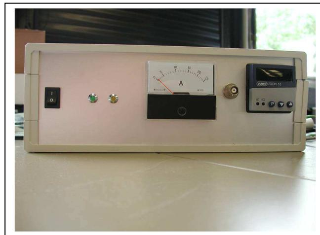
**Abbildung 36: Steuerung zur Temperaturregelung der GC-Transferline für die MPIS**
