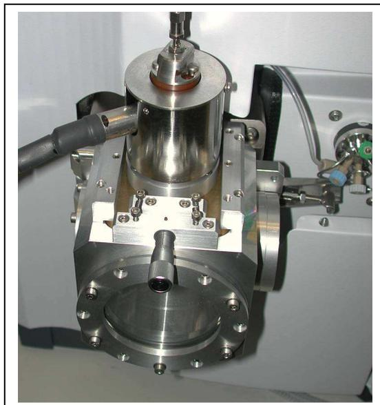
**Abbildung 14: Neu entwickelte LC-APLI-Quelle am microTOF**
