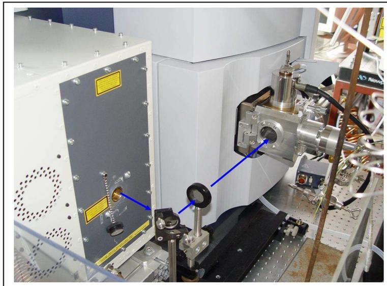
**Abbildung 26: Einkopplung des Laserstrahls in die GC-APLI-Quelle**
