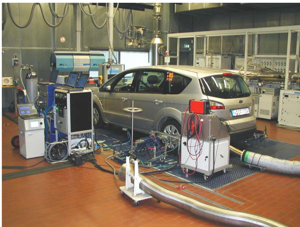
Abbildung A-1: Foto des Messaufbaus am Rollenprüfstand.
