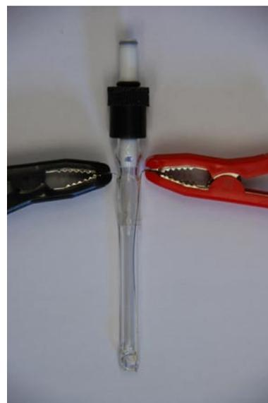
**Abbildung 5.2:** Glaszelle mit Platin-Elektroden ( $\varnothing 0,3$  mm) zur Messung der Leitfähigkeit von  $[(\text{CH}_3)_3\text{Si}][1\text{-C}_2\text{H}_5\text{-CB}_{11}\text{F}_{11}]$  bei 90 °C (PTFE-Ventil (VNMR/5, J. Young, London, England)).<sup>[202]</sup>
