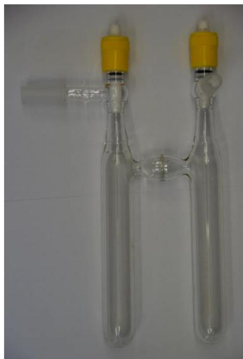
**Abbildung 5.1:** Filtrierapparatur zur Handhabung von luft- und feuchtigkeitsempfindlichen Substanzen (PTFE-Ventil POR/10/RA (J. Young, London, England), Glassfritte D4).
