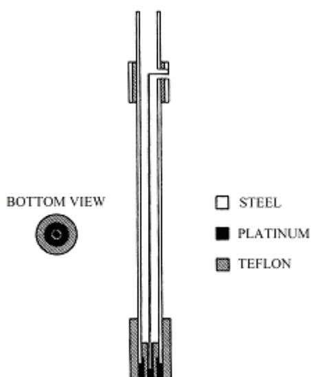
Fig. 8 Rotating ring-disk electrode.
