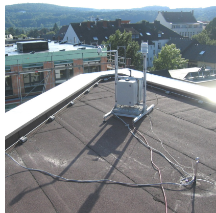
Abb. 91: Wetterstation auf dem Dach.
