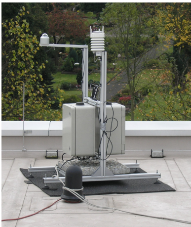
Abb. 21: Mobile Wetterstation zur Erfassung lokaler Wetterdaten am Gebäude.
