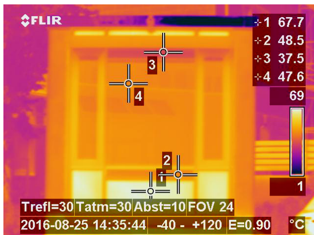
Abb. 327: Thermographie-Bild und Foto der Süd-Fassade der BTGA-Box: Bei einer Gesamtstrahlungsintensität von 710 W/m 2 auf der Fassade, Umgebungstemperaturen von 32 °C und einer mittleren Windgeschwindigkeiten um 1,5 m/s erwärmen sich die Vakuum-Dämm-Paneele im Brüstungsbereich auf 68 °C. Auf Grund der höheren Wärmeleitfähigkeit und der Kühlung durch den Zuluftstrom ist das Lamellenblech am unteren Lüftungselement ca. 20 K kühler. Das verschattete obere Ansauggitter wird durch die Diffusstrahlung lediglich um 5,5 K erwärmt. An der Fensterscheibe führen die vergleichsweise geringe Absorption von Solarstrahlung (ein großer Teil der Direktstrahlung wird auf Grund des Einfallswinkel von 42° reflektiert und wegen des g-Wertes von 42 % führen lediglich 58 % der absorbierten Solarenergie zu einer Erwärmung der Scheibe) und der größere U-Wert zu einer 20 K niedrigeren Oberflächentemperatur als an den Vakuum-Dämm-Paneeelen.
