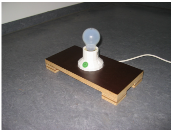
Abb. 222: Eine von vier 60 W-Glühlampen zur Simulation innerer Wärmequellen im Messraum.
