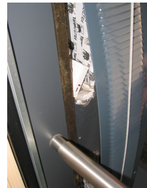
Abb. 97: Kleinlogger zur Messung der Lufttemperatur im Ansaugkanal.
