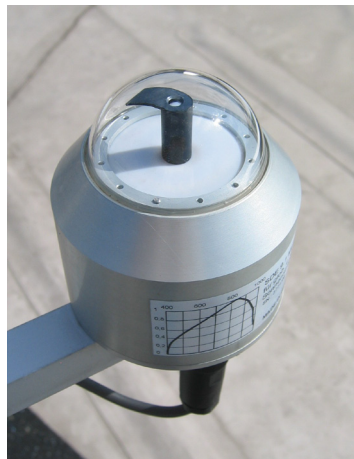
Abb. 22: Kombiniertes Global- und Direktstrahlungssensor an der mobilen Wetterstation.
