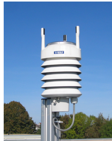
Abb. 23: Sensor zur Messung der Lufttemperatur, rel. Feuchte, Wind- & Niederschlagsdaten.
