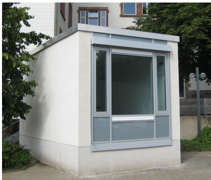
Abb. 208: Messraum "BTGA-Box" mit unterschiedlichen Brüstungskonfigurationen
