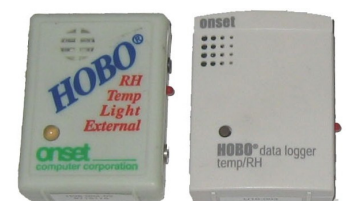
Abb. 26: Batteriebetriebene Kleinlogger zur dezentralen Erfassung von Temperatur und Luftfeuchte.
