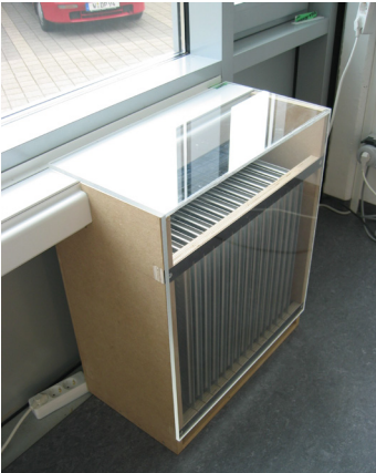
Abb. 228: PCM-Box, ausgerüstet mit 15 PCM-Platten.
