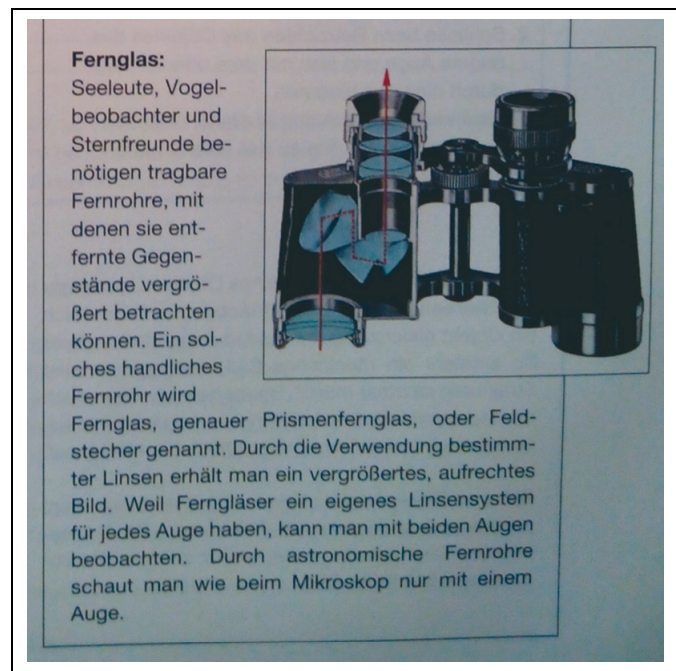
Abb. 109 Das Fernglas als praktische Umsetzung der Eigenschaften von Sammellinsen. 542
