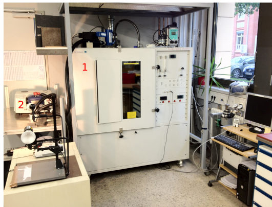
Abbildung 2.1: Smoke Density Chamber (1) mit FT-IR (2)
