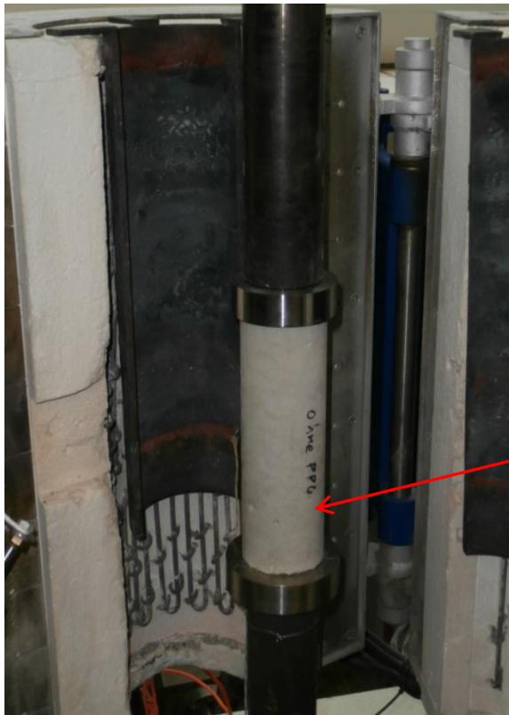
Abbildung 36: Hochttemperaturofen mit Stahlschutzplatten [30]
