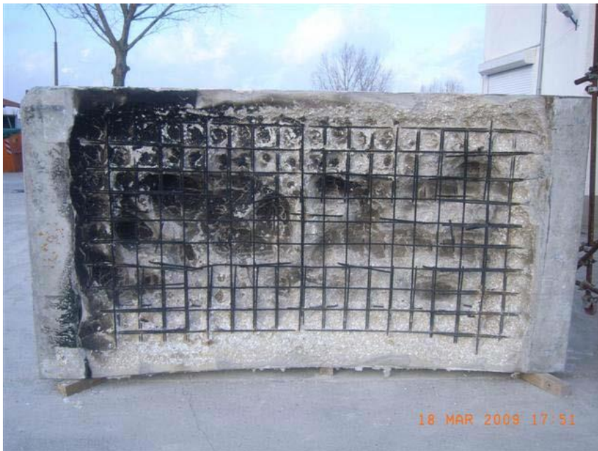
Abbildung 30: Probekörper aus Referenzbeton (ohne PP-Fasern) nach Großbrandversuch [8]
