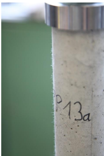
Abbildung 34: Beton-Probekörper mit PP-Fasern [30]
