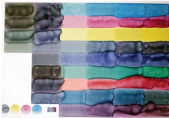
Abb. 62: Trocknungsverhalten bei mit Polyethylen beschichteten Papieren und wässrigem Inkjetdruck
