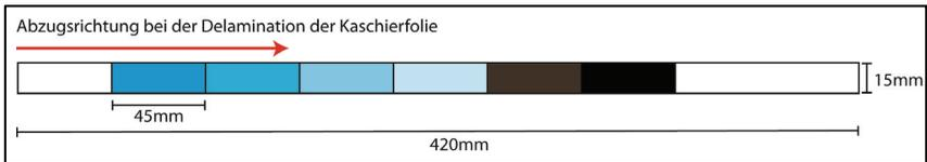
Abb. 59: Probengeometrie und Abzugsrichtung der Kaschierfolie für die Abschälversuche
