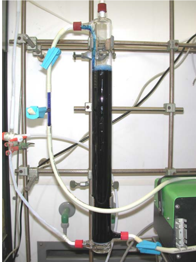
Abbildung 2.7: Entfärbung eines blauen Farbstoffes mit Ozon in einem Blasensäulenreaktor
