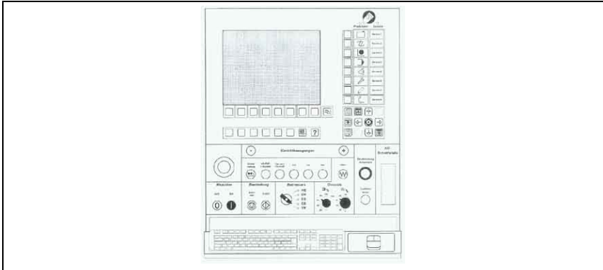
Abb. 2.9: Ein Beispiel zur Umsetzung des Style-Guides für die Bedienoberfläche einer CNC-Fräsmaschine 7
