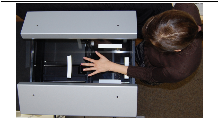
Abb. 3.7: 3D-Scanner zur Erfassung anthropometrischer Daten des Hand-Unterarm-Systems
