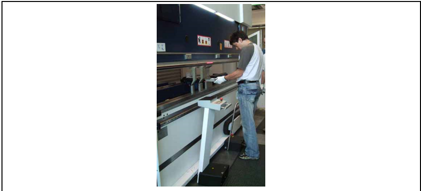
Abb. 2.11: Unterstützung durch eine Konsole mit wichtigen, u. a. fußbetätigten Bedienelementen an der Biegemaschine TruBend 5000
