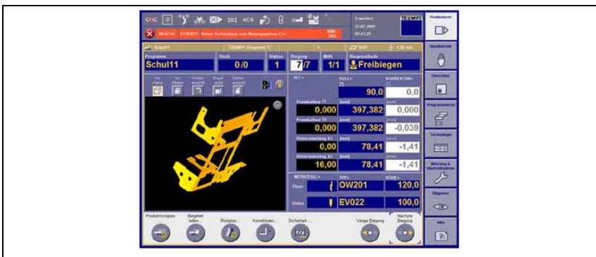
Abb. 2.10: Touchscreen WOP-Oberfläche TruTops Bend einer TRUMPF Biegemaschine 8
