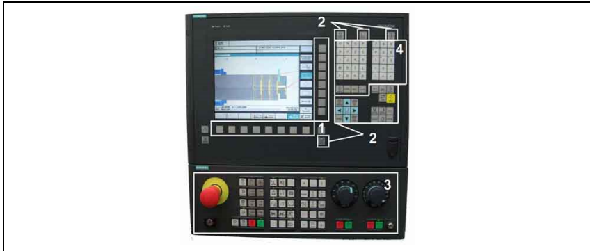
Abb. 2.3: Oberfläche Siemens 810 D für eine CNC-Drehmaschine: 1 – kontextabhängige Tasten (Softkeys); 2 – dialogspezifische Tasten; 3 – maschinenspezifische Tasten; 4 – alphanumerische Tasten.
