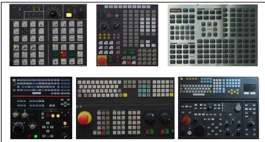
Abb. 3.1: Beispielhafte Darstellung unterschiedlicher Ausführungen von Bedienfeldern
