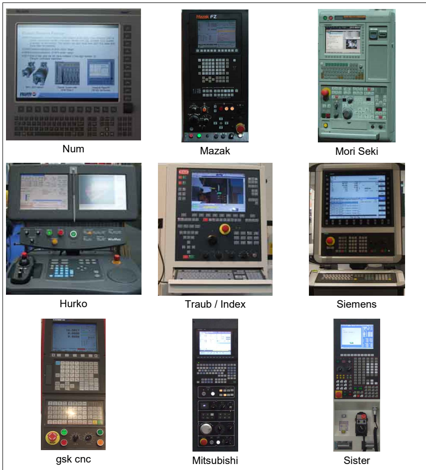
Abb. 2.8: Unterschiedliche Ausführungen von CNC-Bedienpulten
