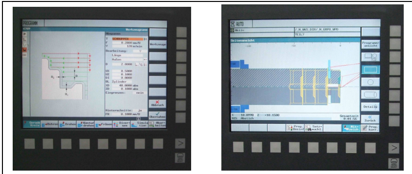
Abb. 2.2: Softkeys im Vergleich am Beispiel einer Oberfläche (Siemens 810 D für CNC-Drehmaschine TC65) bei der Ausführung unterschiedlicher Arbeitsaufgaben
