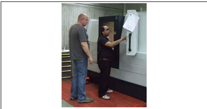
Abb. 2.12 Arbeit an einem CNC-Maschinensteuerstand: Maschinenführer mit unterschiedlicher Körpergröße (l.: 197 cm; r.: 165 cm)
