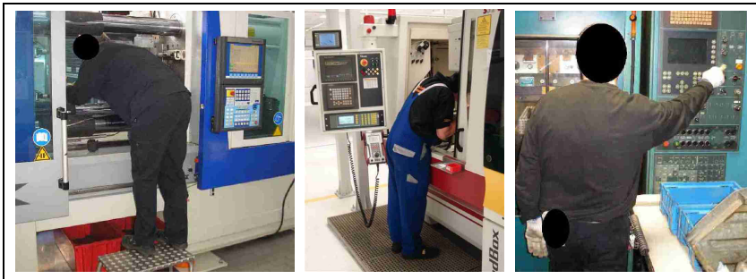
Abb. 4.46: Beispiele ungünstiger Körperhaltungen bei Arbeitstätigkeiten während der Bedienung einer CNC-Maschine
