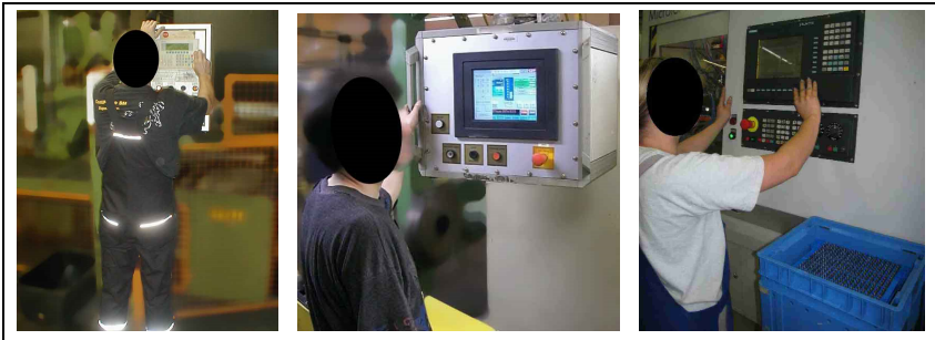
Abb. 4.47: Abstützen auf das Bedienfeld während Programmier- und Überwachungstätigkeiten
