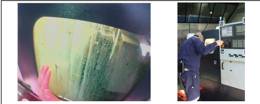
Abb. 4.42: Erschwerte Einsicht in den Fertigungsraum durch Kühlschmierstoffe
