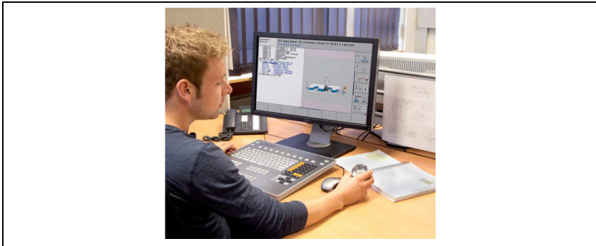
Abb. 2.5: Ein Beispiel eines Programmierplatzes iTNC von Heidenhain 6
