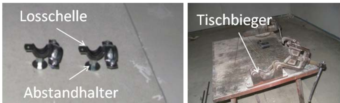
Abb. 30: Befestigte Losschelle und Abstandhalter und Tischbieger für Heizungsrohrleitungen 96
