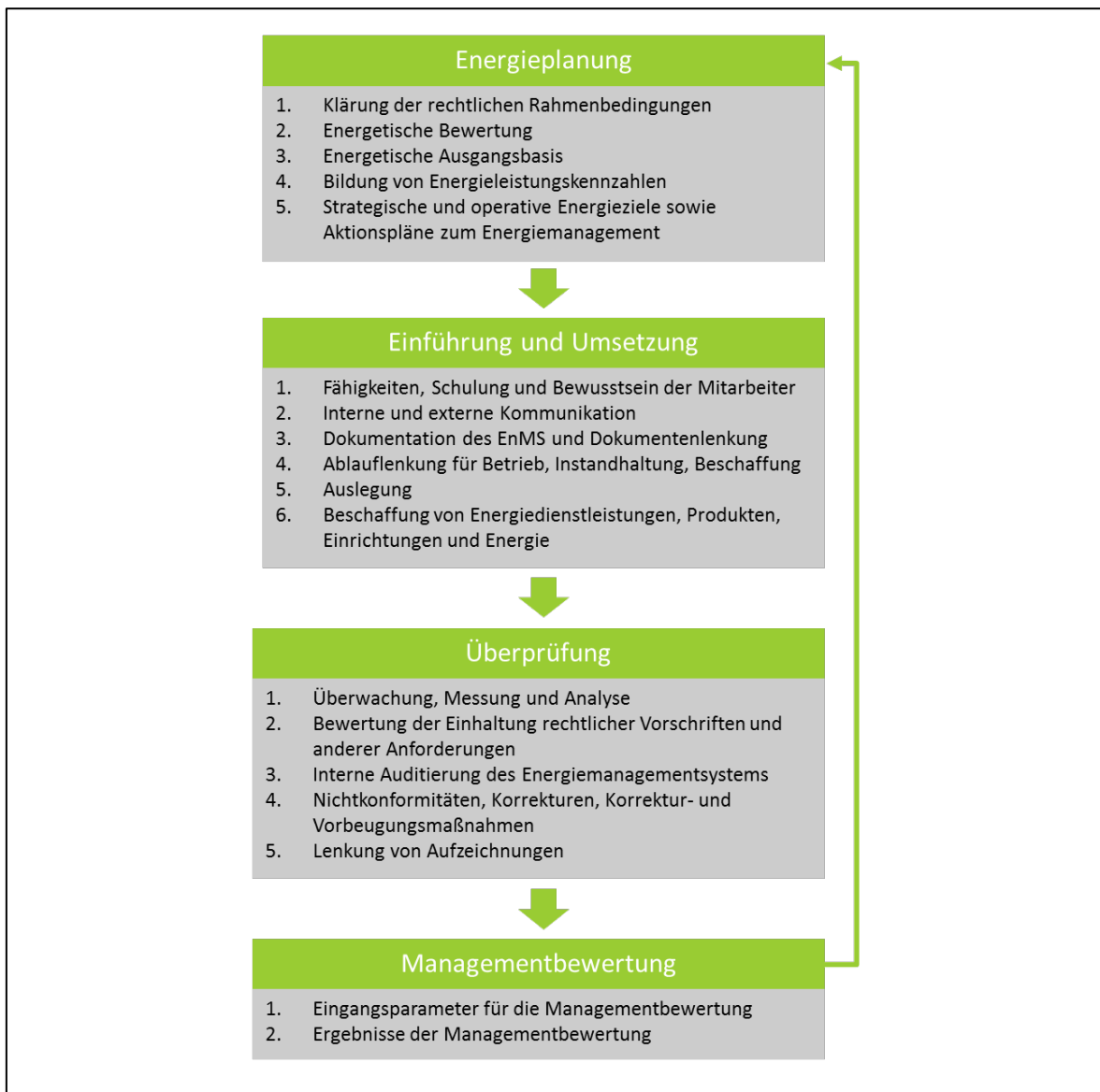
Abb. 5.10: Schritte und Werkzeuge zur Umsetzung eines Energiemanagementsystems 235
