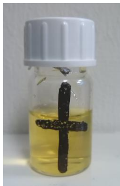
Abbildung 6-5: Präparierung des Schraubdeckelgläschens zur Bestimmung der Länge der Zyklen von Bestrahlen und Schütteln
