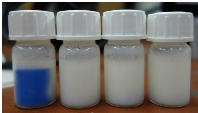
Abbildung 6-14: Bestrahlung der PBB-Suspension mit verschiedenen Lichtquellen (v.r.n.l.: UV-LED-Taschenlampe sowie mit weißem, rotem und grünem Licht einer LED-Taschenlampe)
