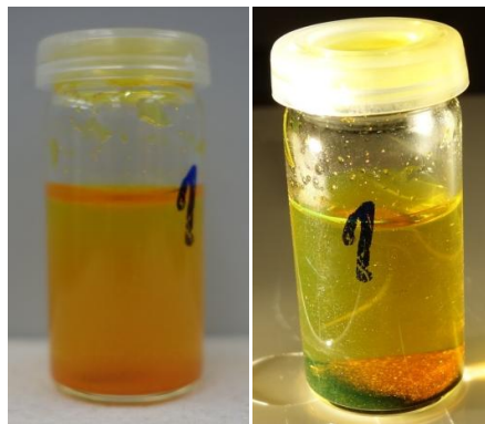
Abbildung 5-4: Photoaktives Merrifield-Harz vor (links) und während der Bestrahlung (rechts)
