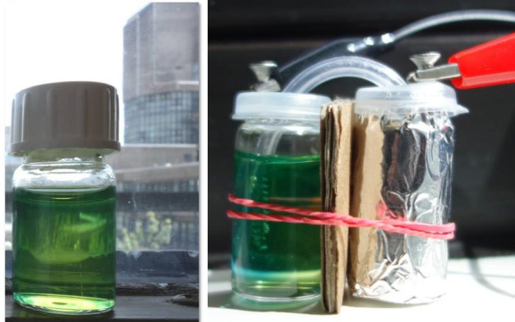
Abbildung 5-55: Reaktionslösung (links) und photogalvanische Zelle (rechts) auf der Fensterbank
