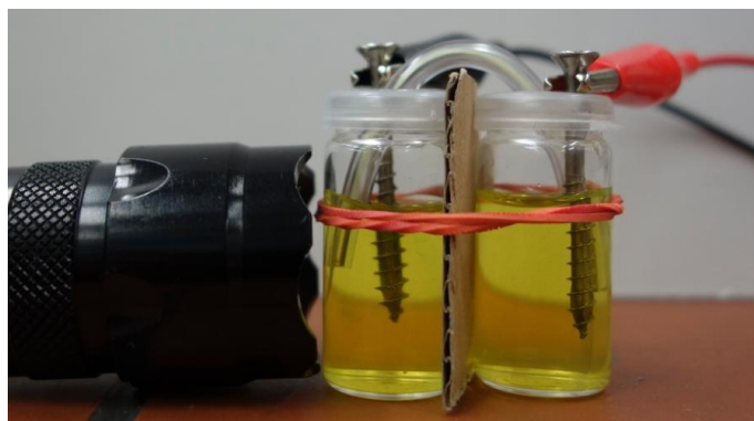
Abbildung 6-10: Microscalige photoaktive Konzentrationszelle
