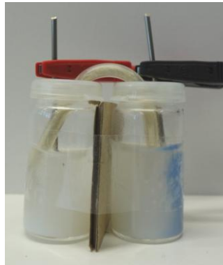
Abbildung 5-58: Photogalvanische Zelle im Microscale-Bereich mit Titandioxid (Hombikat XXS) als Photokatalysator, Triethanolamin als Opferdonor und Ethylviologen als Substrat
