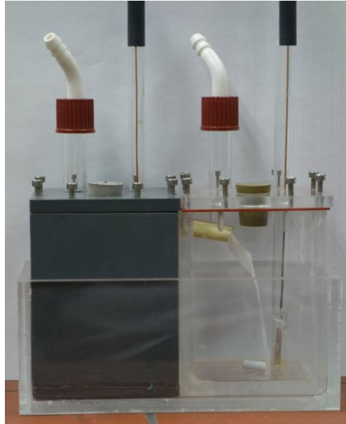
Abbildung 5-43: Photogalvanische Zelle aus PVC und Plexiglas
