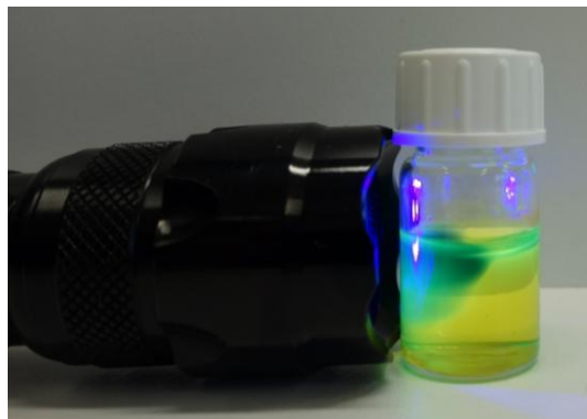
Abbildung 6-4: Das PBB-Grundexperiment während der Bestrahlung mit einer UV-LED-Taschenlampe
