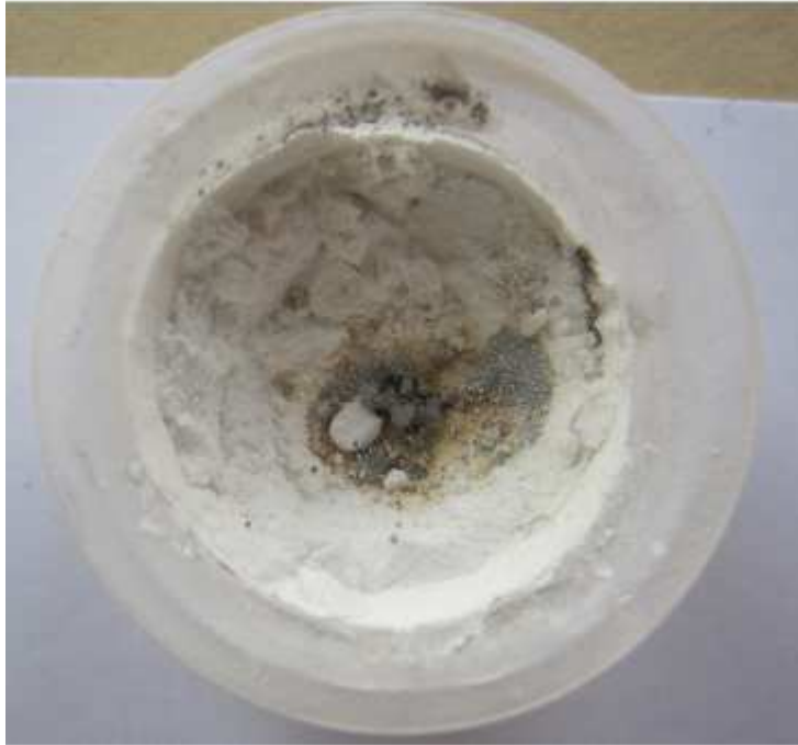
Abbildung 13: Verbrennungsrückstände Brennwertbestimmung Aluminium.
