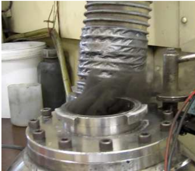
Abbildung 55: Rußhaltige Verbrennungsluft nach Versuch mit hoher Polyethylen-Konzentration.
