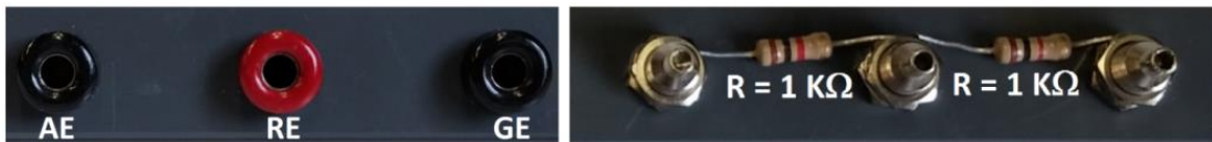
Abb. 21. Dummy Zelle um den ordnungsgemäßen Betrieb des Potentiostats zu überprüfen
