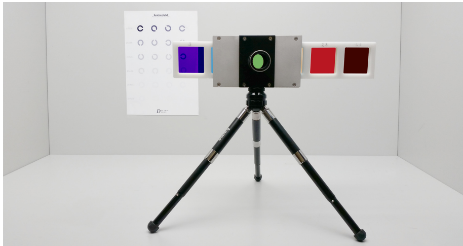
Abbildung 4.20 – Vorrichtung zur Betrachtung einer Kontrasttafel durch Schmalbandfilter.
