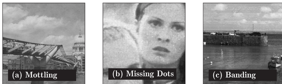
Abbildung 1.3 – Drei Beispiele für druckverfahrenstypische Inhomogenitäten im Druckbild. (a) Mottling - Elektrofotografie; (b) Missing Dots - Tiefdruck; (c) Banding - Inkjet.
