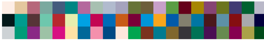
Abbildung 2.3 – Ausschnitt eines Farbcharts zur Körnigkeitsbewertung von Großformatdrucken nach dem im Forschungsbericht 35.0003 beschriebenen Verfahren der Fogra.[5]
