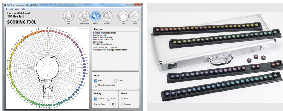
Abbildung 3.8 – Farbanomalietest „Farnsworth Munsell 100 Hue Test“ von X-Rite. Der Test besteht aus 85 Farbkappen, die dem Farbverlauf nach zu sortieren sind. Die Auswertung erfolgt über eine Software.[80]
