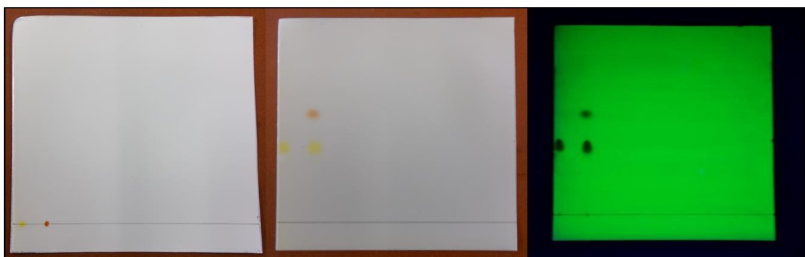
Abbildung 4.27: DC von Diazocin: Links: Z-Diazocin und Diazocin nach Bestrahlung mit \lambda = 365 \text{ nm} . Mitte: Ergebnis der DC unter Laborlicht. Rechts: Ergebnis der DC mit Fluoreszenzindikator F_{254} unter \lambda = 254 \text{ nm} .
