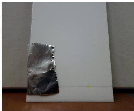
B6 Bestrahlung von Z-Diazocin auf der DC-Folie mit der violetten und anschließend mit der grünen Taschenlampe
