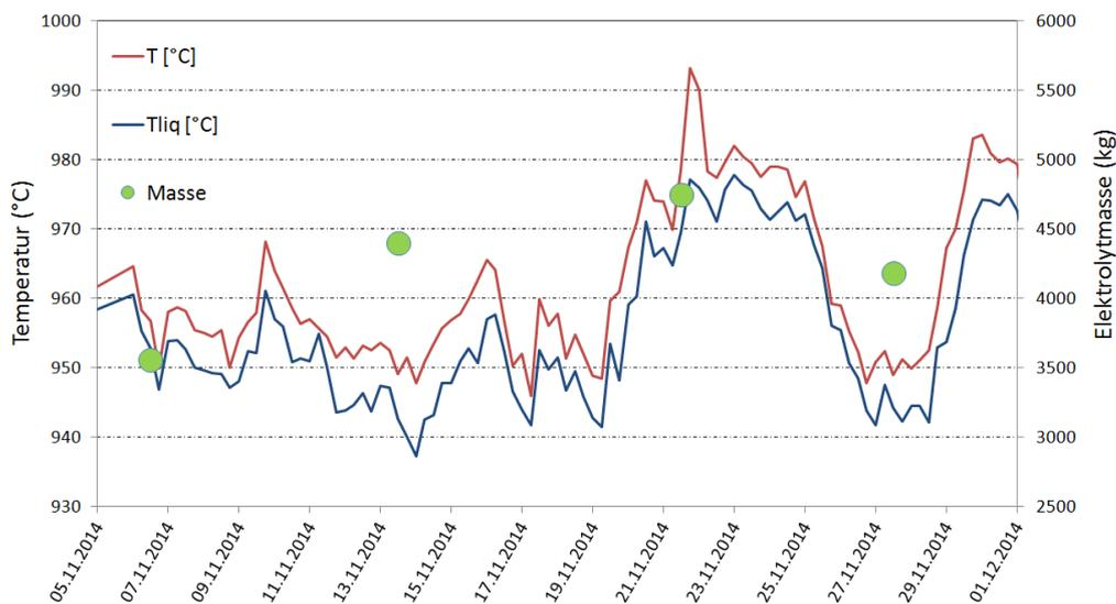
Abbildung 5.31: Elektrolytmasse und Temperaturveränderung Ofen 1112
