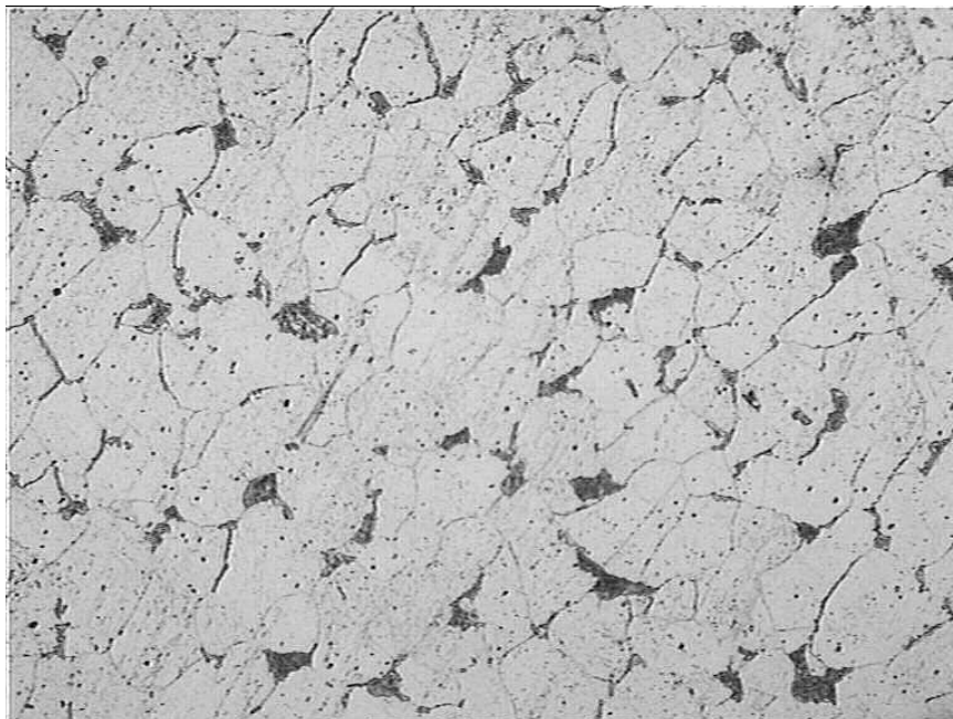
Bild 5.3.15: Schliff zur Bestimmung des Volumenanteils Perlit, V = \text{ca. } 250:1 Werkstoff: S235JO ( \approx St 37-3)
