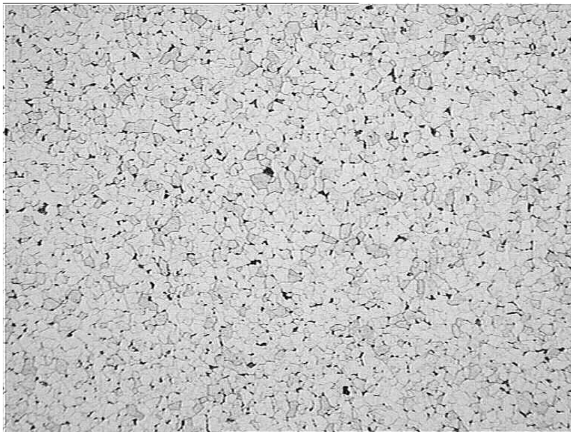
Bild 5.3.6: Ferritisch-perlitisches Gefüge; S235JO (1.0114) nach DIN EN 10025 [116]; unmaßstäbliche Vergrößerung
