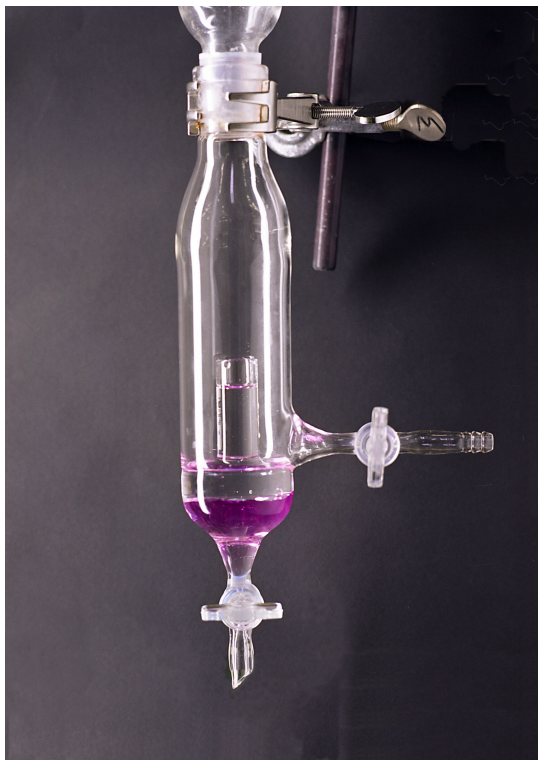
Bild 7.3: Tropftrichter für Absorptionsversuche mit Sammel- und Sperrflüssigkeit (Die Sammelflüssigkeit wurde violett eingefärbt, die darüber liegende Sperrschicht ist farblos.)
