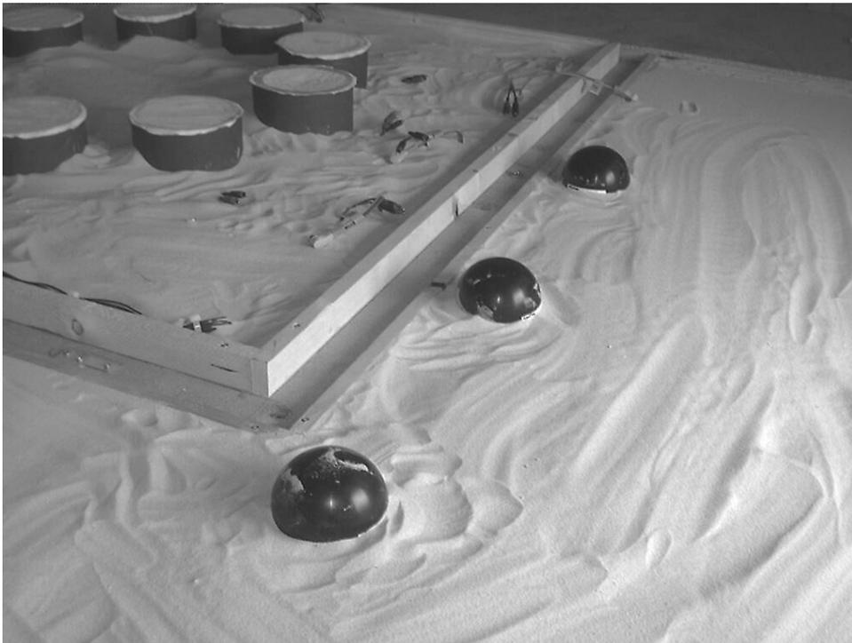
Abb. 4.14: Versuchsaufbau mit Sandaufschüttung für die Körperschalldämpfung
