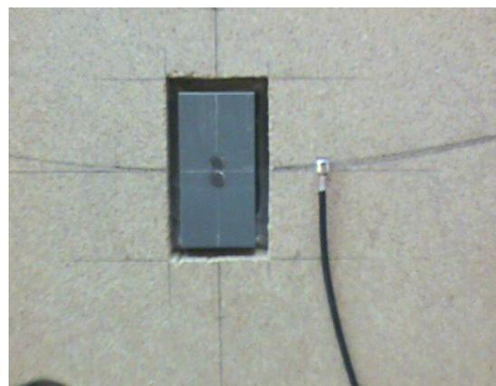
Abb. 4.9 und Abb. 4.10: Messmikrofone im eingebauten Zustand
