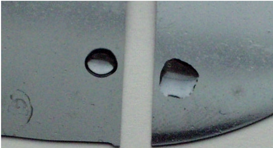
Abb. 53: Verteilung eines Wassertropfens auf einem unbearbeiteten (links) und auf einem mit einem Sauerstoffionenstrahl besputtertem (rechts) Siliziumwafer.
