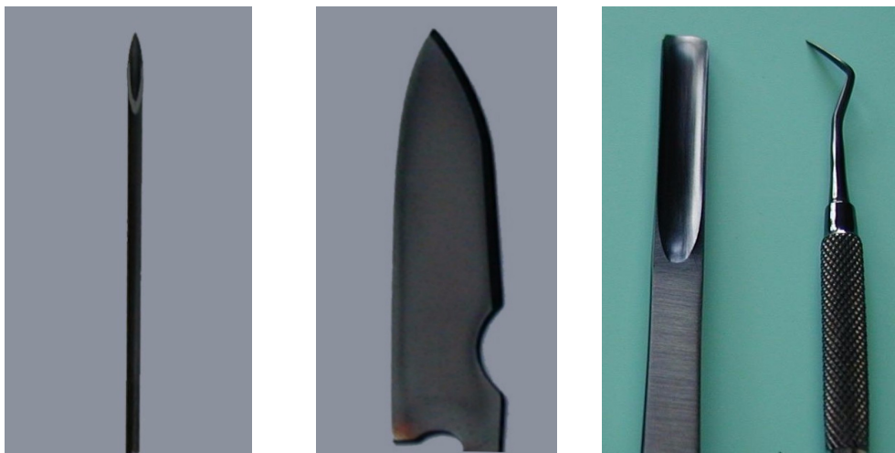
Abb. 7.5: Fotoaufnahmen von Spritznadel, Skalpell und Dentalinstrumenten mit DLC-Schicht.
