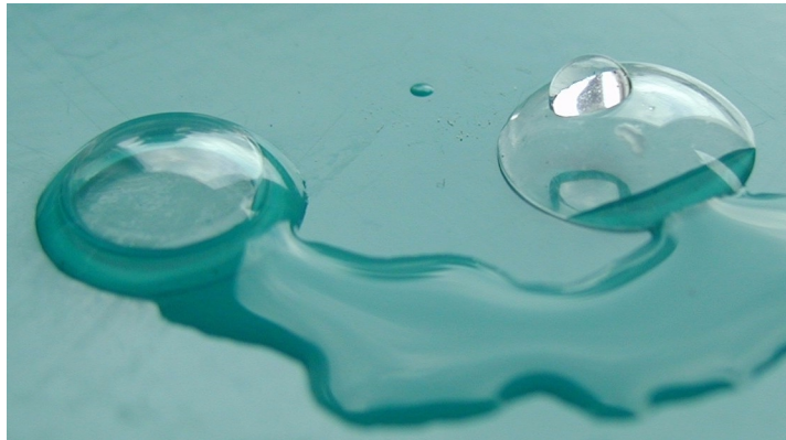
Abb. 7.3: Fotoaufnahme von Silikonkautschuk Kontaktlinsen. Links: DLC-beschichtete Kontaktlinse; rechts: unbeschichtete Kontaktlinse.
