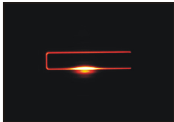
Abb. 6.13: optisches Bild (oben rechts) und photoemissionsmikroskopische Aufnahmen bei Betrieb im Sättigungsbereich (oben rechts) und im Durchbruchsbereich (rechts) eines MOSFETs von der Probenrückseite
