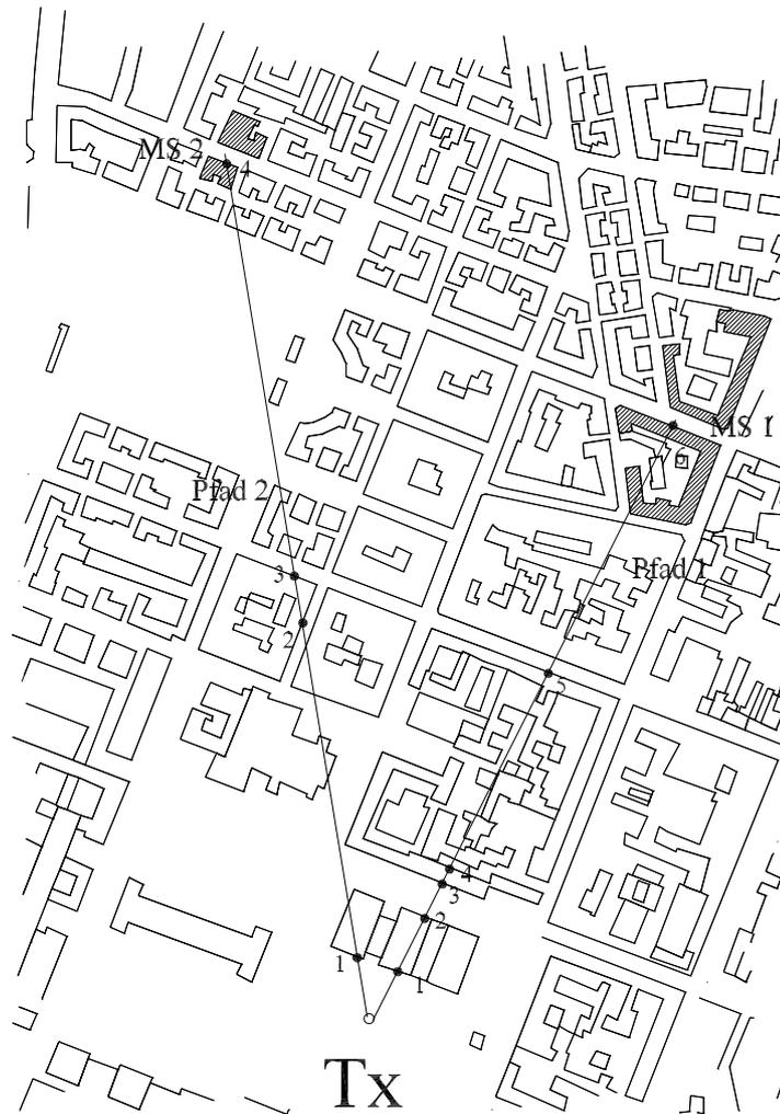
Abb. 7.16: Berechnung der Feldbeiträge von über die Hausdächer sich ausbreitenden Teilwellen. Die Punkte deuten Beugungen an den Dächern.
