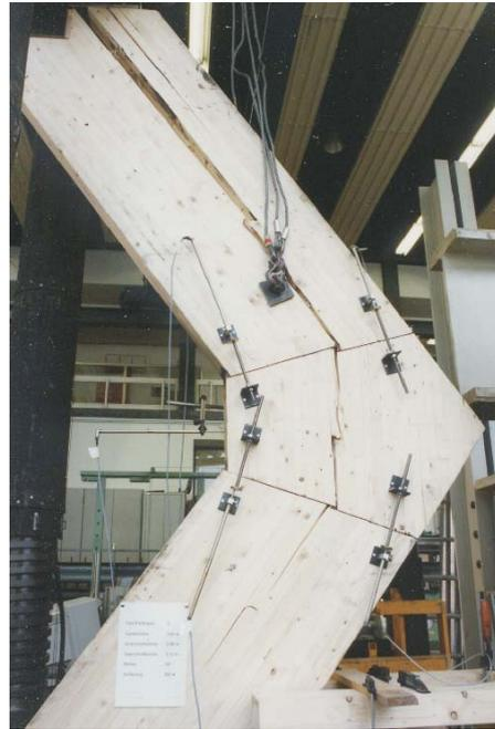
Bild 8.14: Bruchbild Rahmenecke 2a
