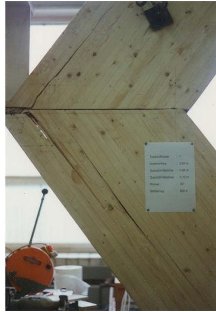
Bild 8.5: Rahmenecke 1a: Bruchbild
