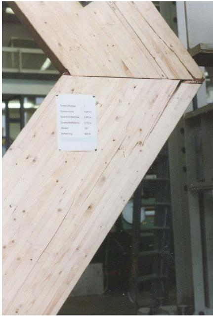
Bild 8.4: Rahmenecke 1a: Bruchbild
