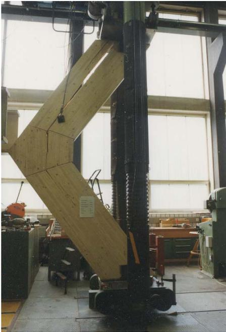
Bild 8.13: Bruchbild Rahmenecke 2a
