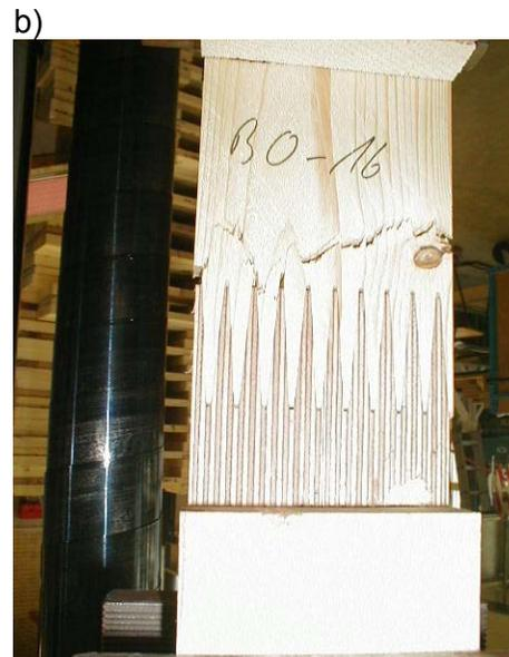
Bild D.1: a) Bruch im Bereich der Verstärkung; b) Bruch außerhalb der Universalkeilzinkenverbindung
