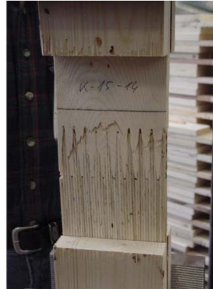
Bild E.1: a) Bruch überwiegend im Zinkgrund des FSH-Q
