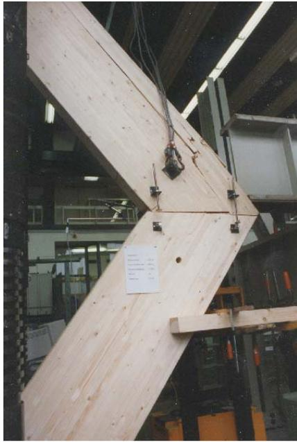
Bild 8.8: Rahmenecke 1b: Bruchbild
