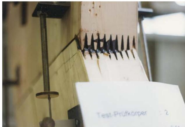
Bild 8.12: Quetschfalten an der unteren UKZV der Rahmenecke 2a
