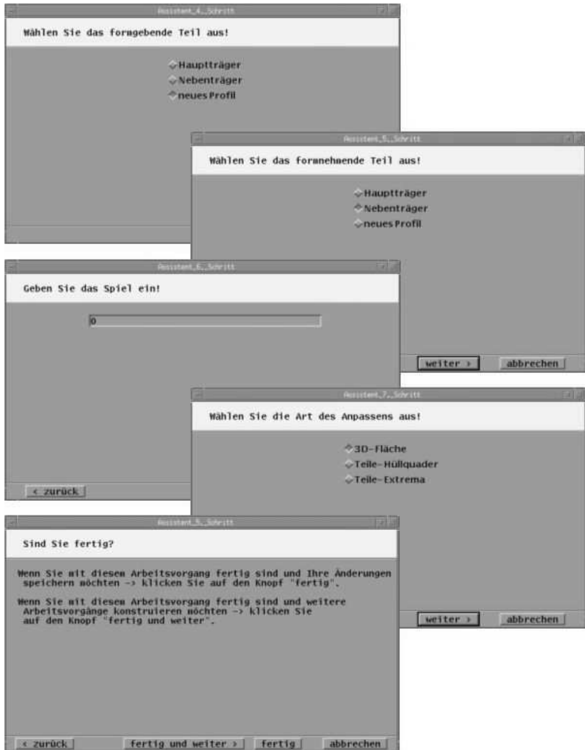
Abbildung 5-12: Aufzeichnen des Arbeitsvorgangs Geländer an die Platte anpassen
