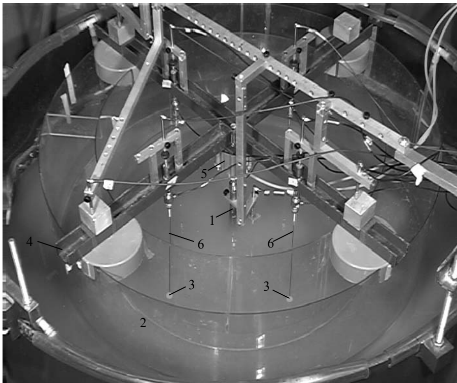
Abbildung 5-22: Versuchsaufbau der Zug-Druck-Kombination
