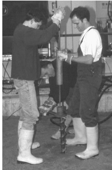
Abbildung 5-16: Pfahleinbau ab 60 cm Länge
