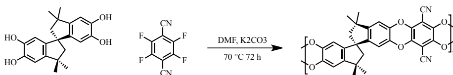
Abbildung 8: Darstellung des chiralen (+)-PIM-CN von Weng et al. 48
