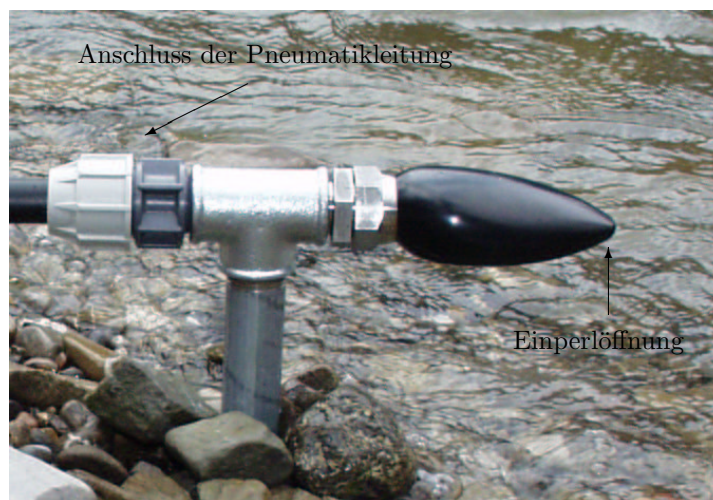
Bild 4.6: Strömungsgünstig geformter Einperlsensor aus Kunststoff (Fa. Ott Hydrometrie, 2001)
