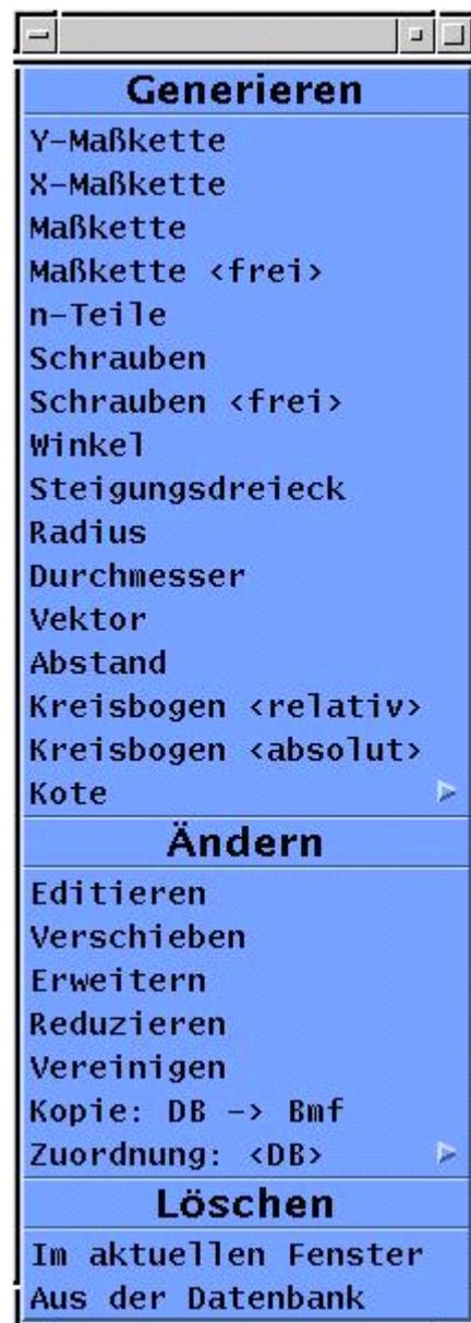
Bild 5-25: Befehlsliste „Bemaßen“, Werkbild BOCAD
