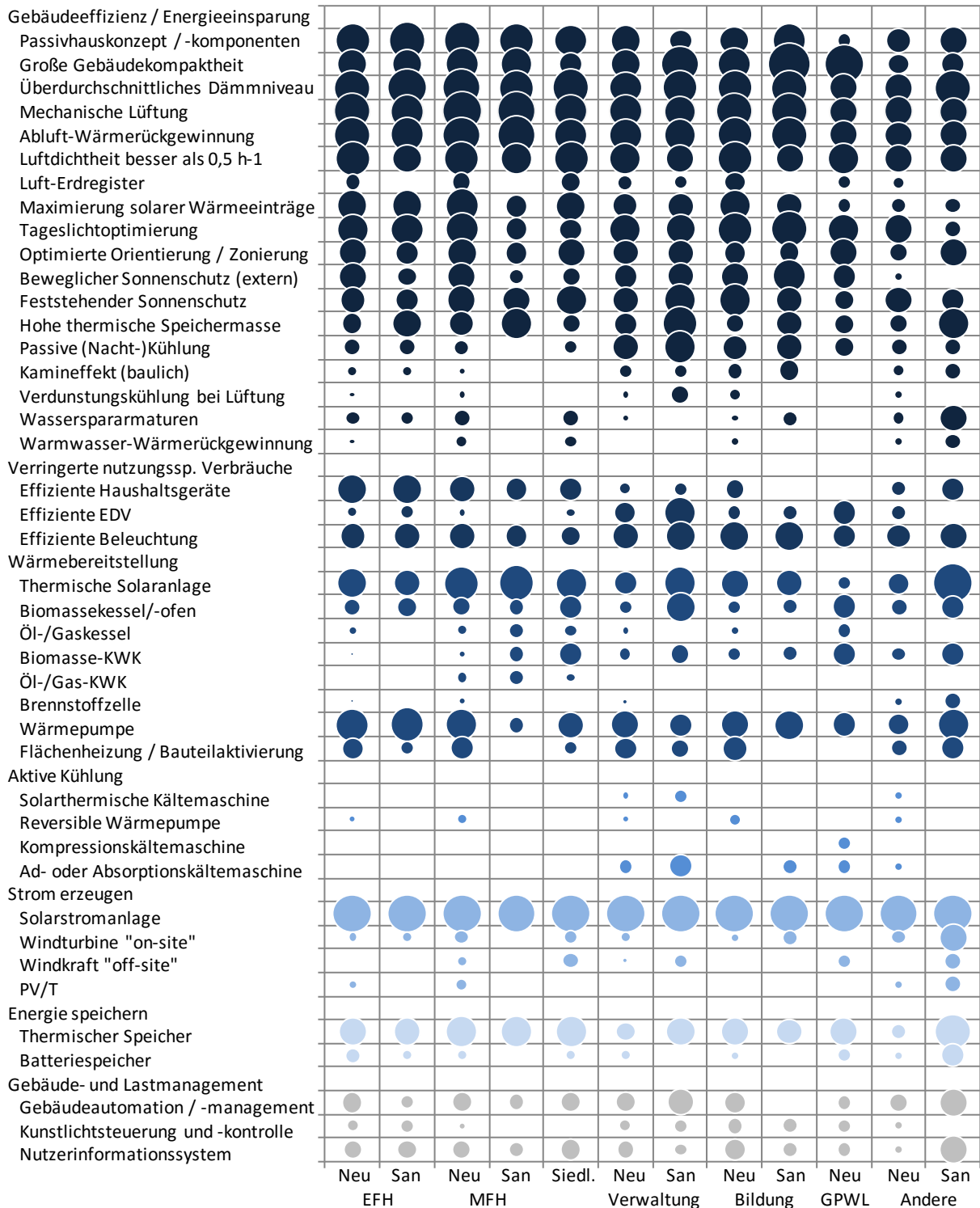
Abbildung 8-33: Verteilung genutzter Strategien und Maßnahmen zur Energieeffizienz, -einsparung, -bereitstellung und -erzeugung bei Nullenergiegebäuden in heizungsdominierten Klimaten (da in diese Auswertung bzw. Aufstellung alle gut 340 bekannten Gebäude der gemäßigten Klimazone eingehen, aber das Energiekonzept mitunter nicht zu jedem Gebäude vollständig bekannt ist, zeigt sich hier lediglich ein Trend zur Verteilung der Maßnahmen). Eine Blase in Höhe eines Feldes entspricht einer wahrgenommenen Anwendung von 50 %, die Blasengrößen beim Punkt Solarstromanlage entspricht bei allen Typologien 100 %.
