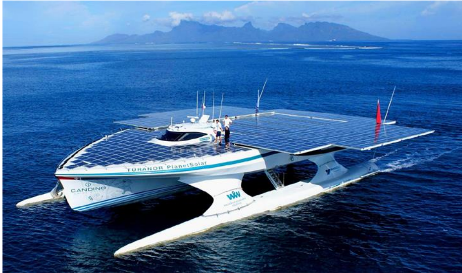
Abbildung 4-3: Beim größten solarbetriebenen Schiff der Welt, der MS Turanor Planet Solar zeigt sich stellvertretend die Auswirkung eines rein auf Sonnenenergie basierenden aber auf Grund einer während des Betriebs nicht möglichen Netzanbindung autarken Ansatzes durch die eine massive Ausweitung der verstellbaren Solaranlagen auf weit über 500 m 2 (120 kW p ) und einer damit einhergehenden Überformung bzw. tlw. Entfremdung der eigentlichen Schiffsform. Um auch nachts fahren zu können, wird tagsüber generierter Strom in Lithium-Ion-Batterien gespeichert. Quelle Internet, Foto Planet Solar
