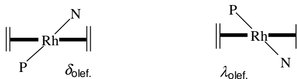
Abbildung 20: Definition der Nomenklatur für die Konformation eines Metall-Diolefin-Chelatrings. Das Diolefin ist oberhalb und der P,N-Ligand unterhalb der Papierebene angeordnet.
