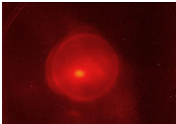
Abbildung 3-7: Abbildung des Dunkelstroms eines supraleitenden Injektors auf einen YAG-Bildschirm. Die hellen Ringe entsprechen parasitärer EFE vom Kathodenrand und der helle Punkt in der Mitte dem Photostrom [119].
