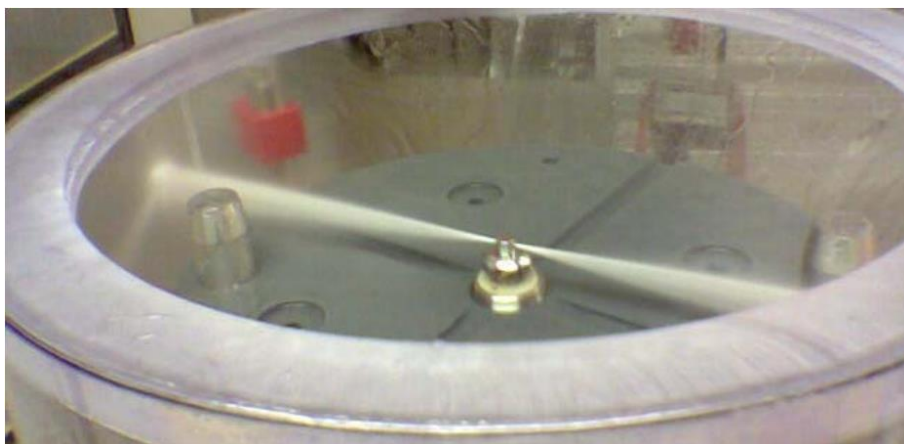
Abbildung 4-5: Hochdruckwasserspülanlage am DESY mit zwei entgegengesetzten Düsen, sowie einer rotierenden Platte, auf der die Proben installiert werden [138].
