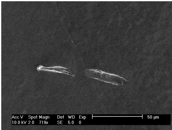
Abbildung 6-12: REM-Aufnahme (a) eines typischen Kratzeremitters mit stabiler EFE (b, \beta = 18 , S = 5,3 \times 10^{-3} \mu\text{m}^2 , E_{on} = 222 \text{ MV m}^{-1} ).
