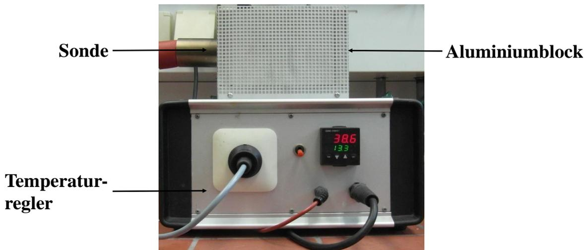
Abbildung 27: Apparatur zur Bestimmung der Temperaturabhängigkeit der fouling-kompensierenden NIR-Sonde auf die Basislinie.
