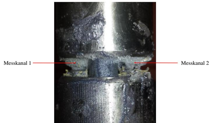
Abbildung 33: Partikuläre Ablagerungen auf der NIR-Sonde.
