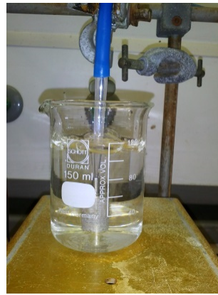
Abbildung 59: Versuchsapparatur zur Aerosolgenerierung durch Metallfritten
