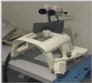
Abbildung 84: Video-Goggles, angebracht auf der oberen Hälfte der 2-teiligen Kopfspule
