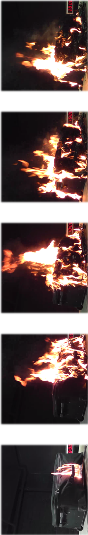
Abbildung 6.2: »Hauptversuch 1«, Impressionen bei Zündung, nach 5 min, 10 min, 15 min und 20 min Versuchsdauer
