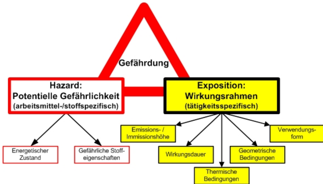
Abbildung 1.1: Beispiele stoffspezifischer Aspekte des Gefährdungsmodells [3, 4]
