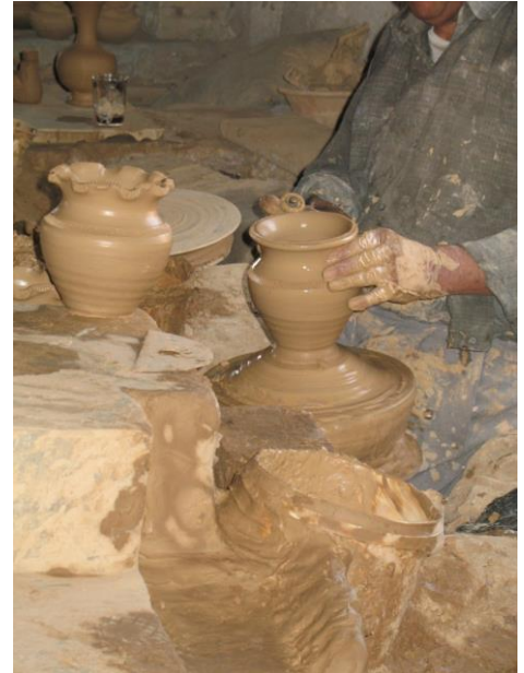
Abb. 3.10 Formung von Krügen auf einer mechanisch angetriebenen Töpferscheibe (Töpferei bei Zarqa, Sommer 2006)
