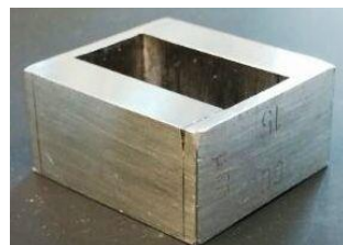
Abbildung 35: Foto eines Rakels [103] . Für die Präparation wurden einige Tropfen Dispersion in das Rakel gegeben und dieses gleichmäßig über das Substrat gezogen. Es entstehen feuchte Filmstreifen der gewählten Höhe.
