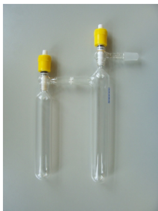
Abbildung 9.1: Reaktionsgefäß für Arbeiten mit verflüssigtem \text{SO}_2 mit eingebauter Glasfritte und J. Young Hähnen.
