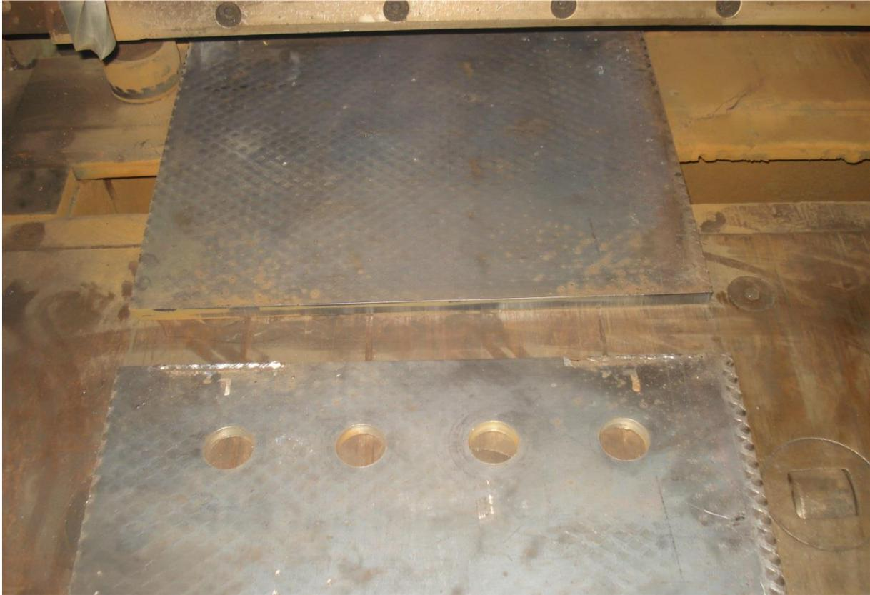
Bild 7.4-5: Endschnitt des fertigen Bauteils als Kopfschnitt des Folgeteils
