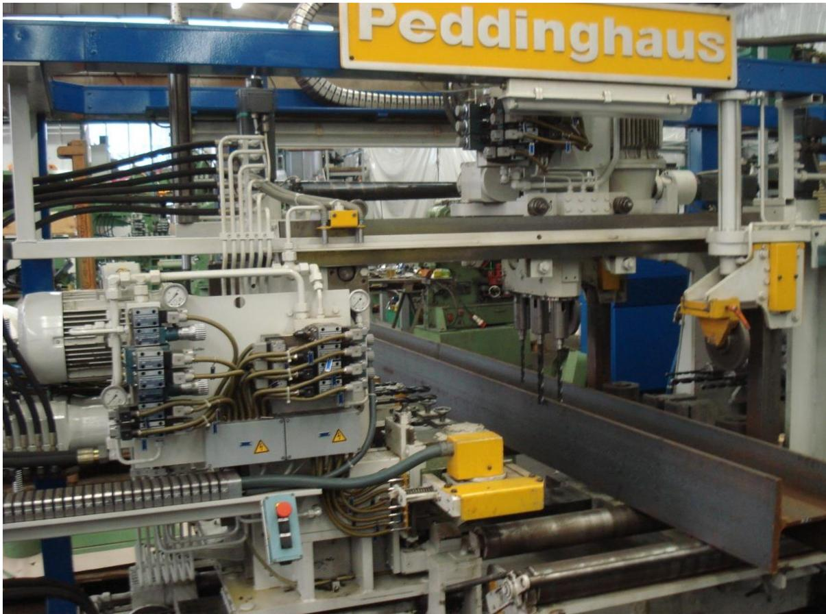
Bild 5.2-13: CNC-Bohr-/Körn- und Signierzentrum der Fertigungslinie „Träger“
