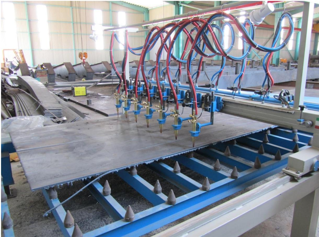
Bild 6.3-3: Streifenschneider mit landesüblichen Propanbrennern
