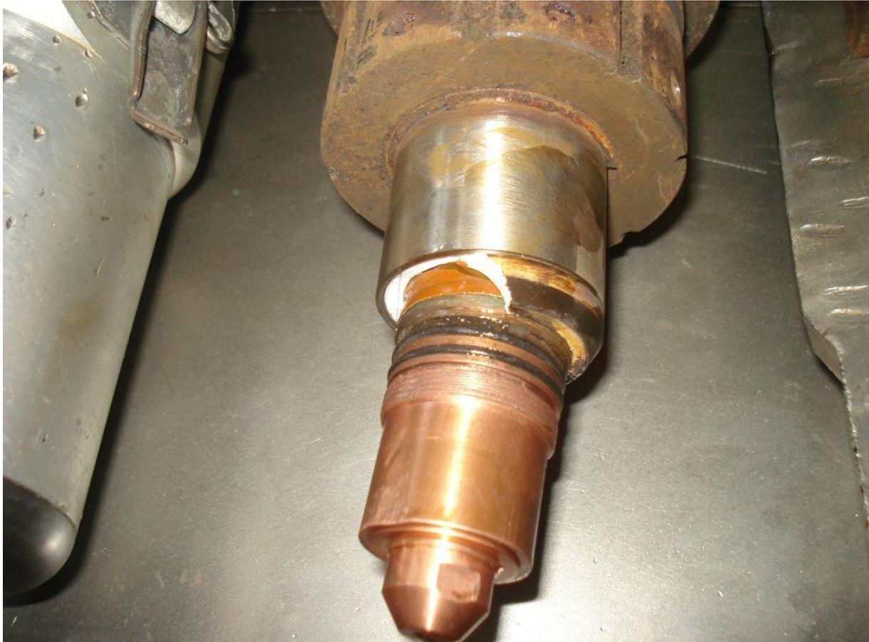
Bild 7.2-4: Havarie des Plasmabrenners, irreparabler Bruch
