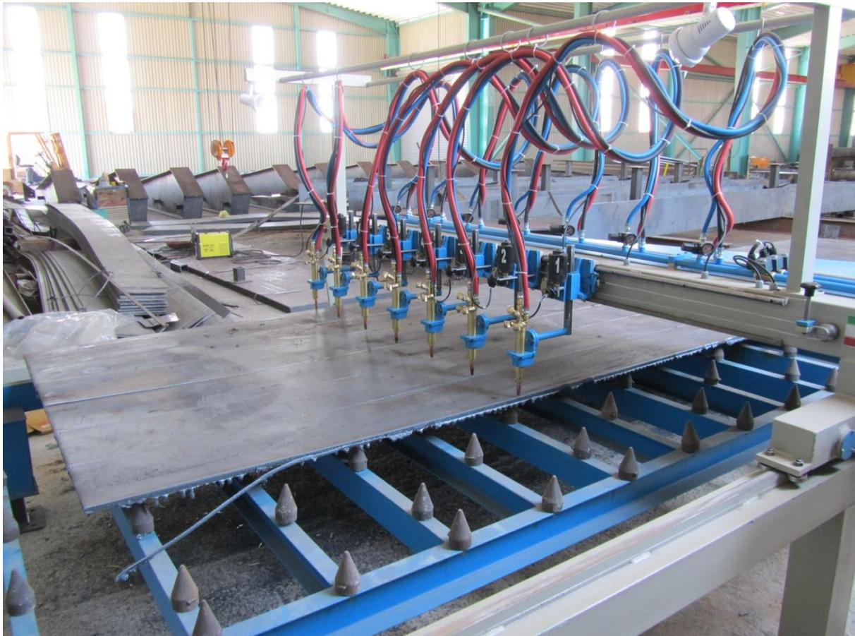
Bild 7.2-2: Parallelbrenner zum Autogenschneiden von Blechstreifen
