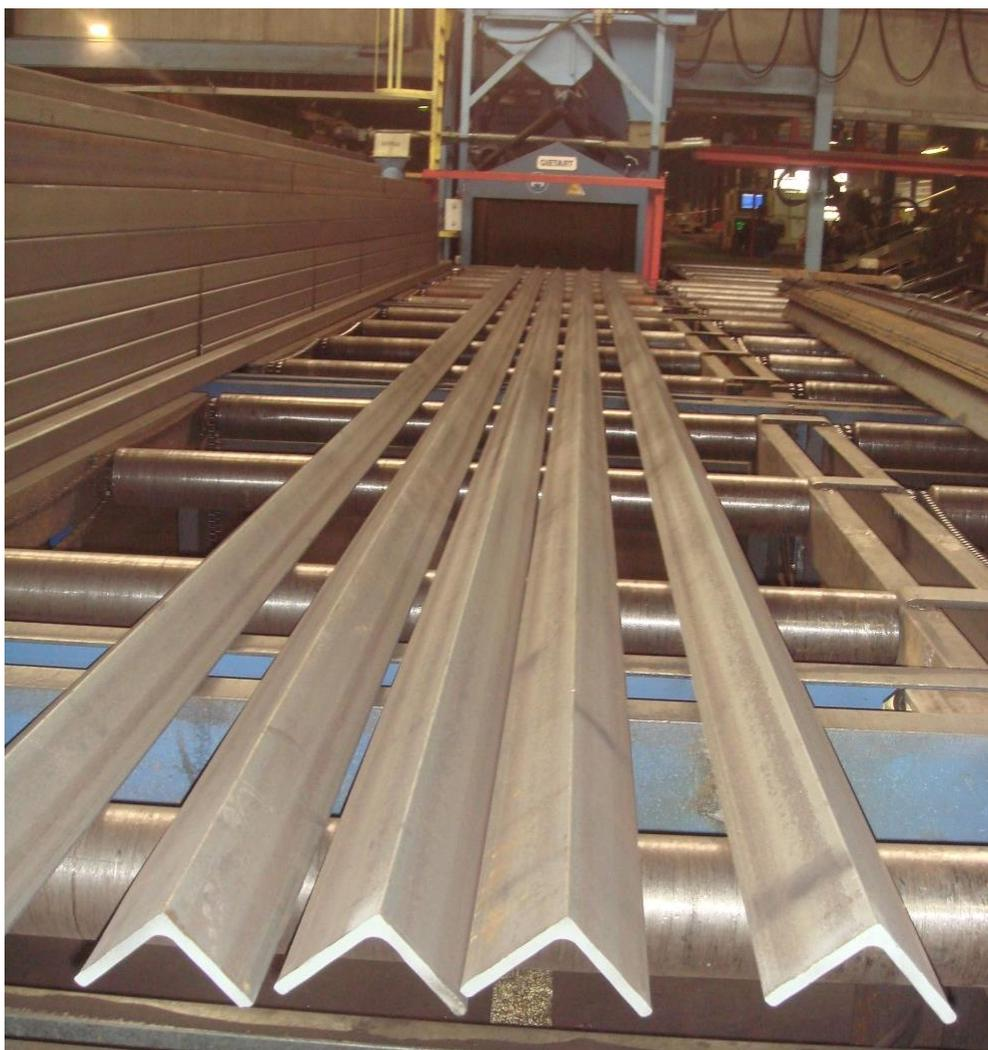
Bild 5.2-9: Eingangswalzen der Strahlanlage, Nutzung der Strahlbreite
