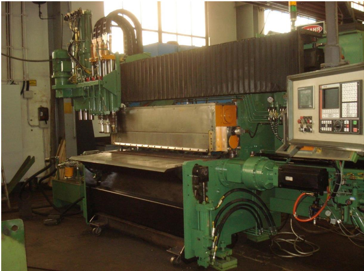
Bild 7.2-1: CNC-Blechbearbeitungszentrum, Kern des Muster-Werks
