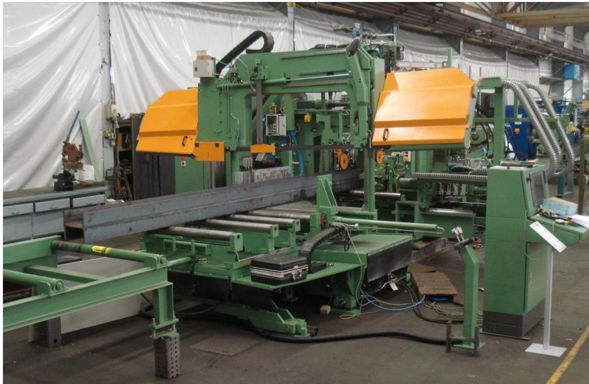
Bild 5.2-12: Schwenkbare CNC-Bandsäge, auch für Paketschnitte
