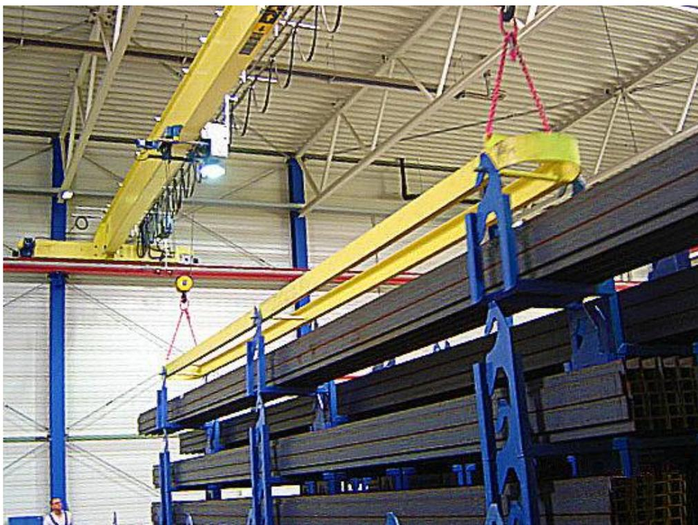
Bild 5.2-11: Selbstkuppelnde Stapelkassetten, kein Anschlagen einzelner Träger
