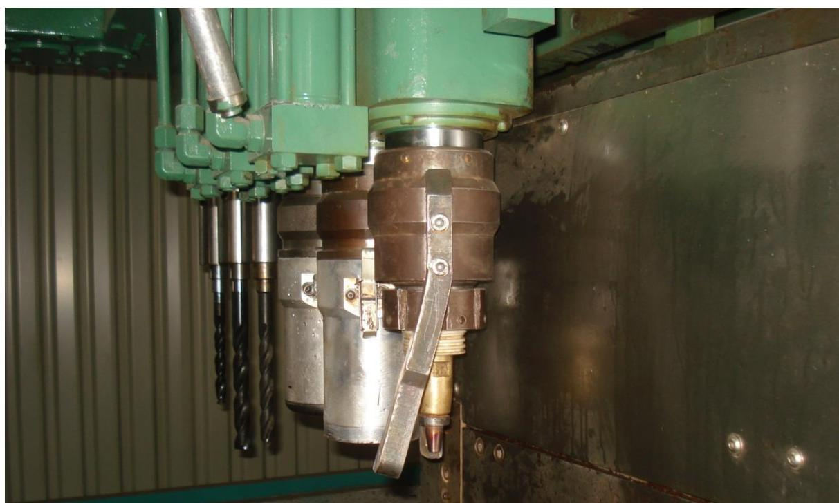
Bild 7.2-3: Havarie der Zündbacke bei Inbetriebnahme im Entwicklungsland
