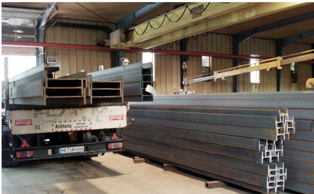
Bild 5.2-7: LKW-Materialanlieferung, Traversen-Magnetkran, Pufferlager
