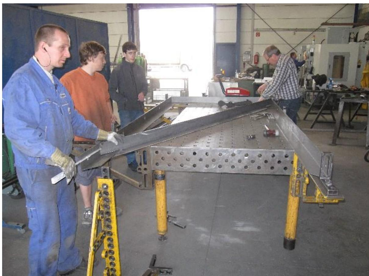
Bild 7.5-4: Fertigung eines erdbebentüchtigen Stahlfachwerks für Tansania
