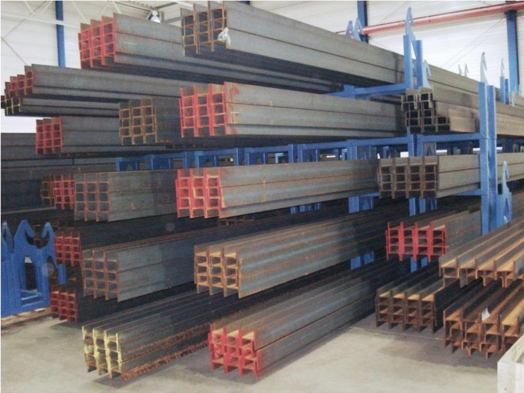
Bild 5.2-10: Stapelkassetten mit Termingruppen von Walzprofilen
