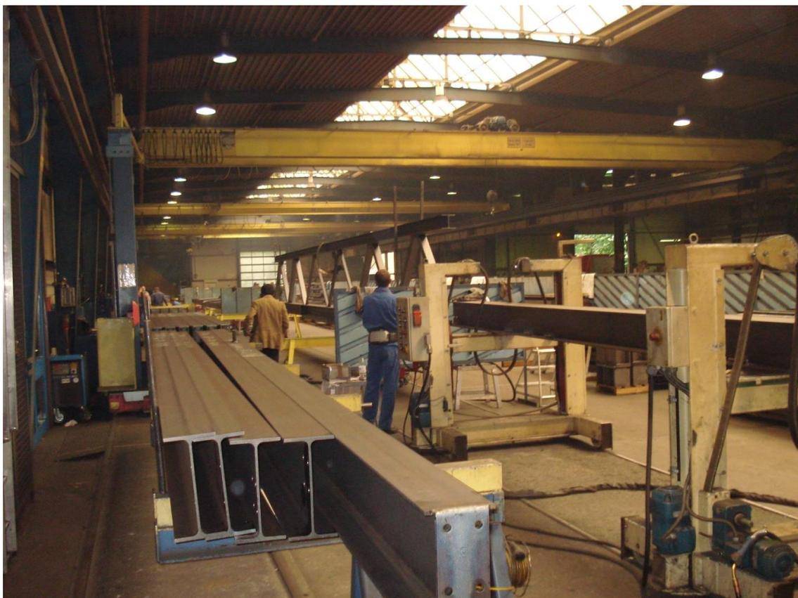
Bild 5.2-16: Schienengeführter Schwenkgabelstapler mit Paket fertiger Träger
