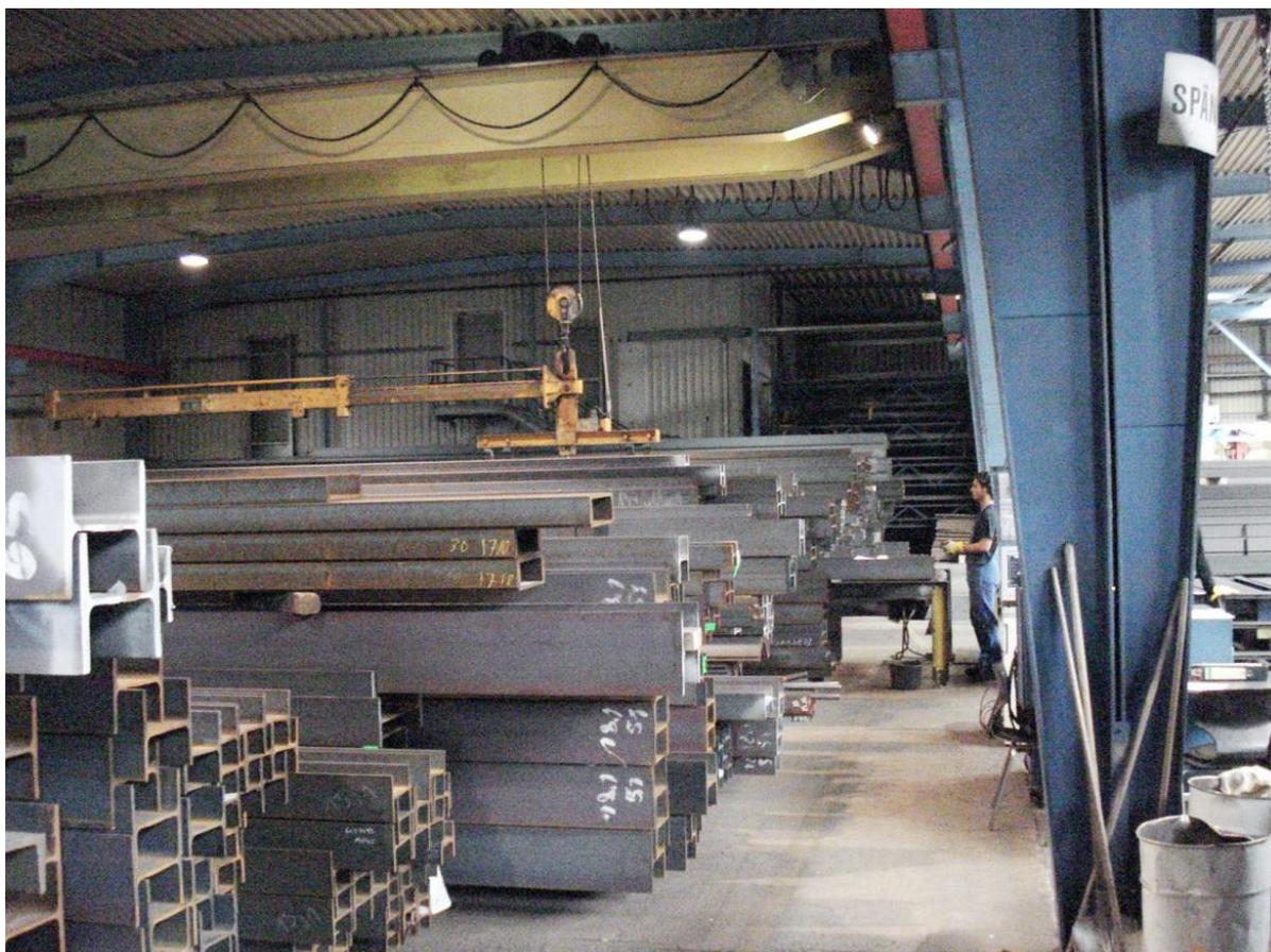
Bild 5.2-8: Traversen-Magnetkran belädt Rollgang der Strahlanlage
