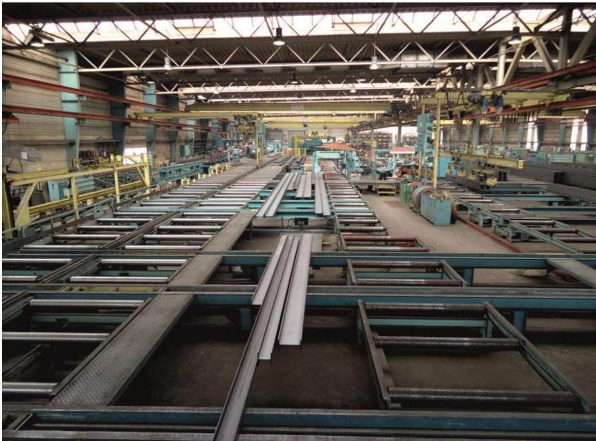
Bild 6.3-4: Flurförderung: Rollgänge und Quarförderer
