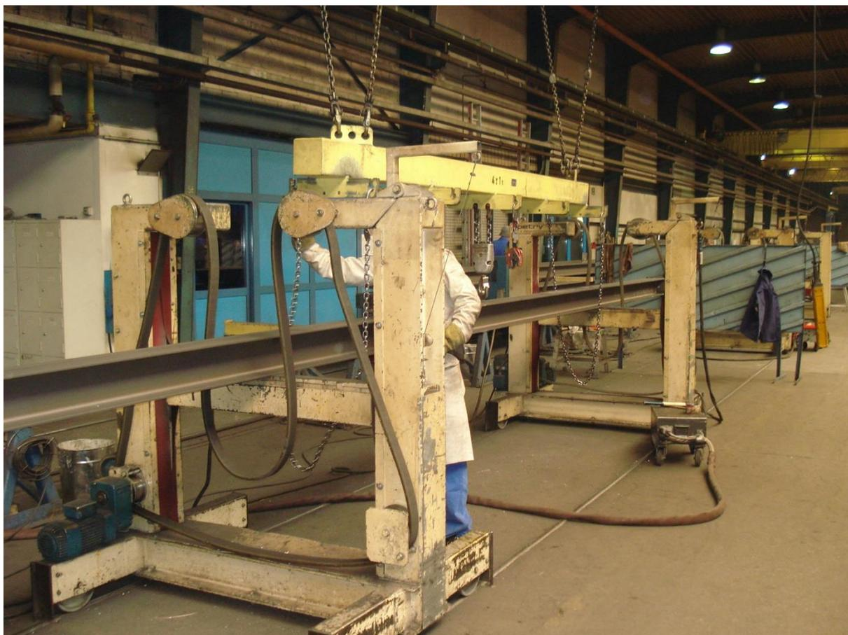
Bild 5.2-15: Zusammenbaustation mit Wendomat und lokalem Magnetkran
