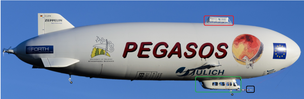
Abbildung 3.1.: Zeppelin NT während eines Messfluges. Instrumente befinden sich in der Topplattform (rot umrandet) und in der Kabine (grün umrandet). An der Mastspitze (schwarz umrandet) sind Sensoren für meteorologische Parameter und Einlässe von anderen Instrumenten in der Kabine installiert.
