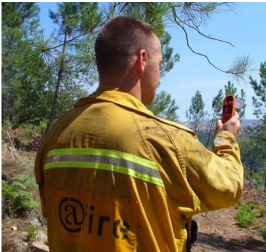
Abb. 7.3.2/4: Mobile Wetterstationen (hier von Kestrel) können gerade bei bergiger Topographie vor Ort wertvolle lokale Wetter-Informationen nicht nur für die Einweisung von Luftfahrzeugen liefern. Sie sollten daher mindestens bei den Zugführern der Einheiten im Bereich der Feuerfront verfügbar sein. (Foto: @fire)
