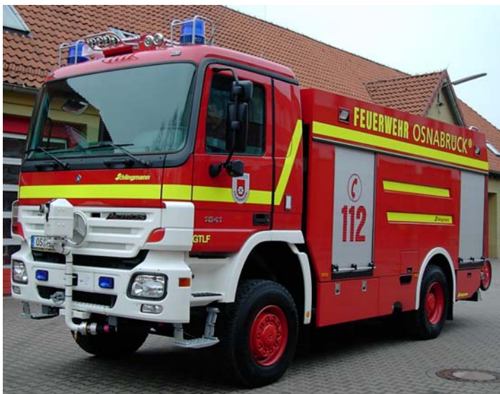
Abb. 6.3.1/10.a: TLF 6000 1 (TLF 24/60) der BF Osnabrück (Schlingmann auf MB Actros 1841 AF). 6.000 L Wasser, 1.000 L Schaummittel, Druckzumischanlage und eine HD-Pumpe sowie einen funkferngesteuerten Werfer. (Foto: Feuerwehr Osnabrück)
