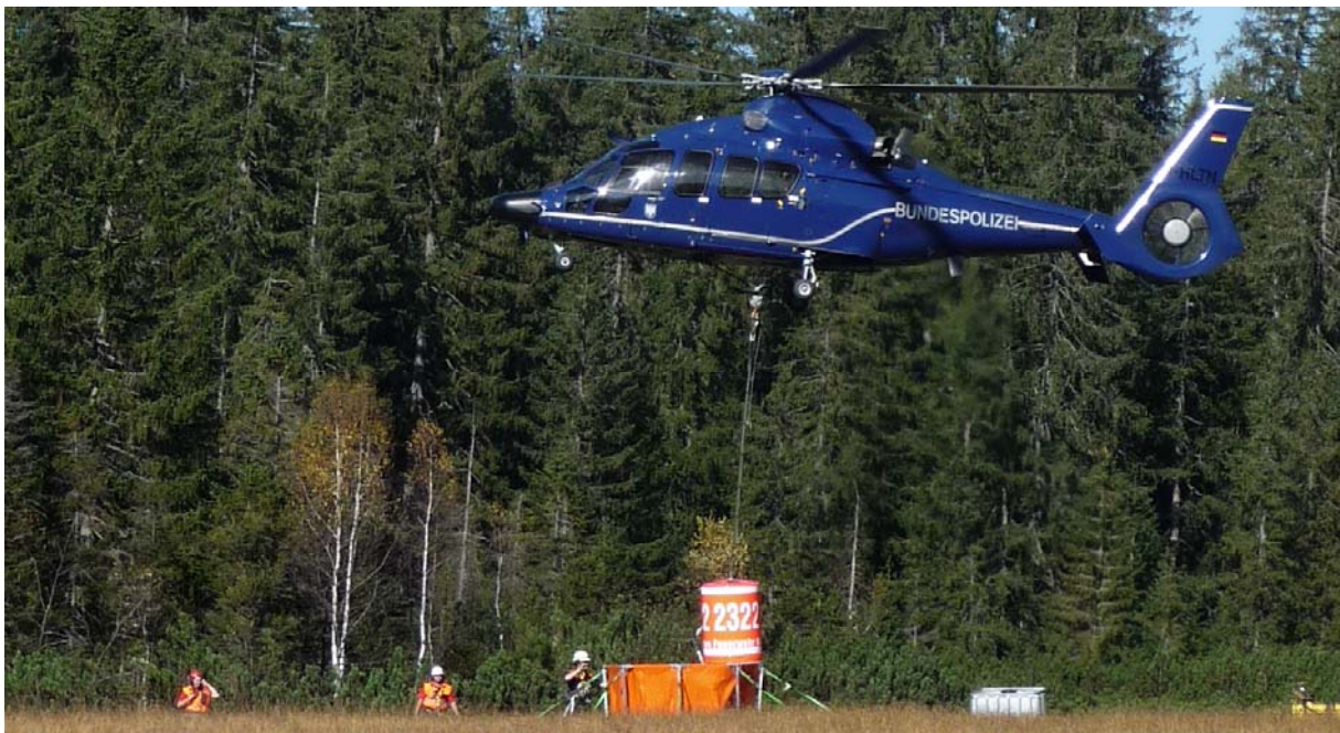
Abb. 5.1.8/3: Bayerische Flughelfer bei einer Übung. Der Pilot soll den relativ kleinen (auch eingeflogenen) Behälter 1 , der auf einem Hochplateau ohne Wasserversorgung steht, mit dem LAB am Hubschrauber füllen. Ohne kundige Einweiser klappt das so eher durch Zufall als durch Können. (In diesem Fall hat es selbst mit Einweiser nicht beim ersten Mal geklappt. Der Löschwasseraußenlastbehälter setzte auf dem faltbehälter auf und drohte ihn zu beschädigen oder gar zu zerstören. (Foto: Cimolino)
