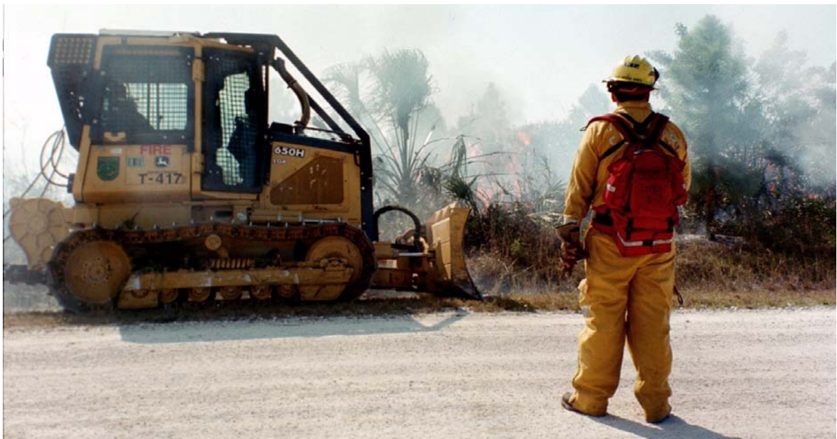
Abb. 6.3.3/7: Kettenfahrzeuge mit Kabinen- und z.T. auch seitlichem Kettenschutz werden v.a. in den USA in einigen Bereichen mit großem Erfolg von den Feuerwehren bzw. den Forstbehörden verwendet. (Foto: Südmersen)
