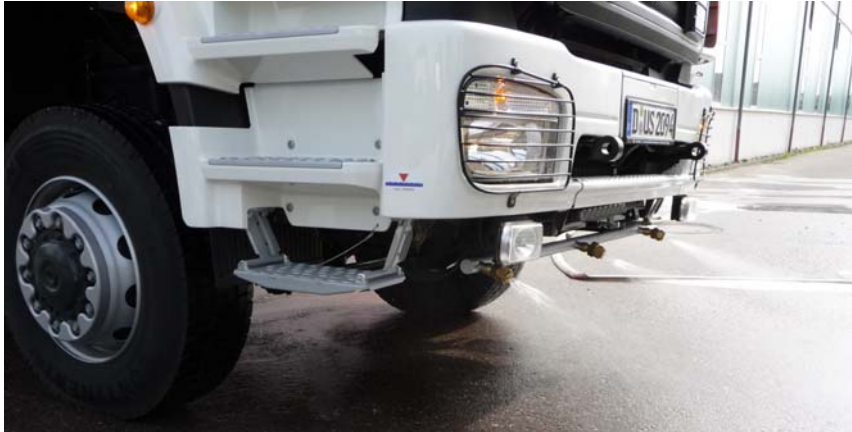
Abb. 6.3.1/3: Löschdüsen sollen Flammen vom Fahrzeug wegdrücken bzw. direkt löschen. Sie sind deshalb nach vorne bzw. unten gerichtet. Hier Frontlöschdüsen an einem PTLF 4000 der Feuerwehr Düsseldorf. (Foto: Cimolino)
