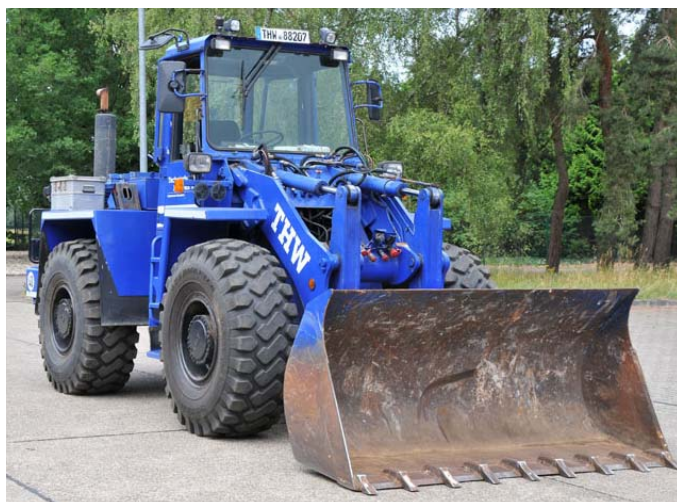
Abb. 2.5.1/3: Mit Bergungsräumgeräten bzw. Radladern des THW lassen sich nicht nur Wege bauen, sondern auch Schneisen anlegen. (Foto: Truckenmüller, Düsseldorf)
