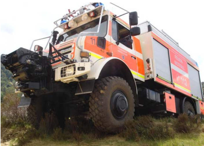
Abb. 5.1.6/7: Spurgleiche, singlebereifte Allradfahrzeuge (hier ein TLF 3000-W der Feuerwehr Düsseldorf) mit ausreichender Bodenfreiheit und großen Rampen- und Überhangwinkeln mit selbstreiner Geländebereifung bieten die besten Möglichkeiten abseits befestigter Straßen 2 . (Foto: Cimolino)
