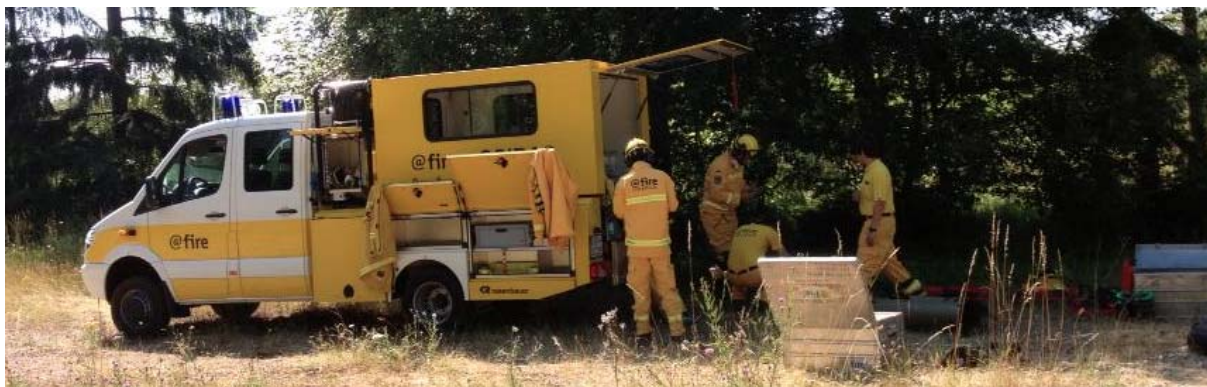
Abb. 6.3.1/16: Multifunktionales Fahrzeugkonzept von @fire (Material-, Personaltransport, Pumpenaufsatz, Behelfs-KTW), vgl. ZAWADKE, 2013. (Fotos: Zawadke, Neu-Ulm)
