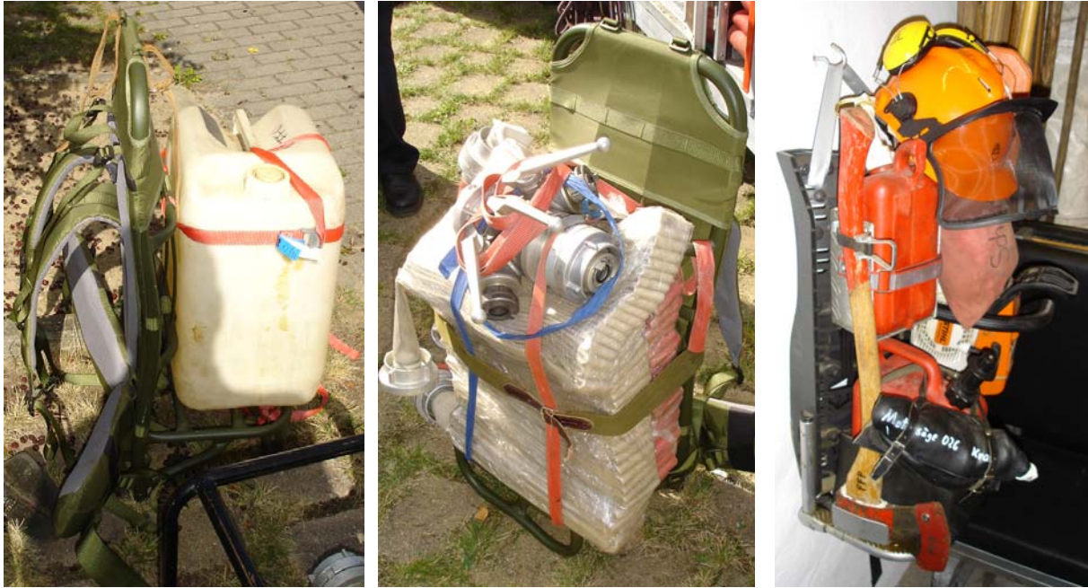
Abb. 6.1.6/5 - 7: Kraxen von links nach rechts: Schläuche 1 und Armaturen, Netzmittel, Axt und Kettensäge inkl. PSA dafür, vgl. auch Abb. 6.3/3. (Fotos: Cimolino)
