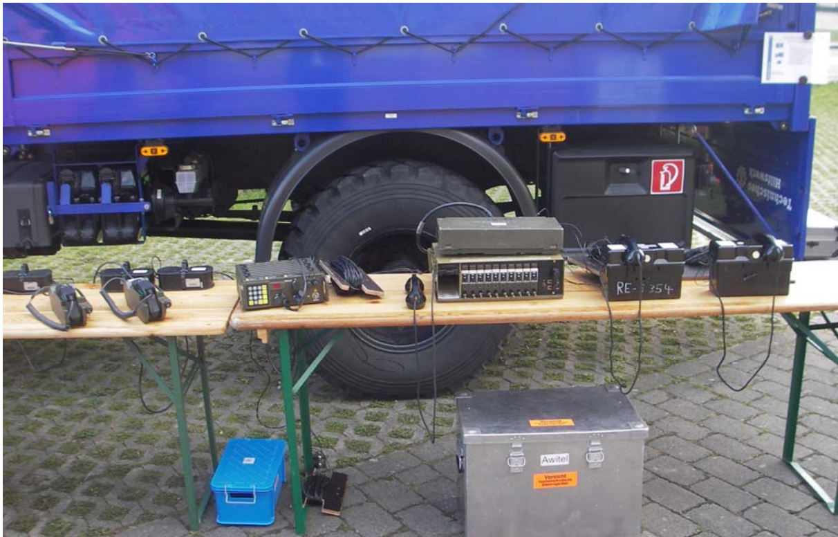
Abb. 7.2.3/4: Die AWITEL 1 -Anlage ermöglicht je nach Ausführung die Selbstwähl- bzw. Vermittlungstelefonie und die Einbindung von weiteren Kommunikationstechniken. Ein bewährtes System, das neben dem THW auch einige Feuerwehren (z.B. Dortmund) vorhalten. Die Produktion ist aber leider seit Jahren eingestellt. (Foto: Neuhaus, Arnsberg)
