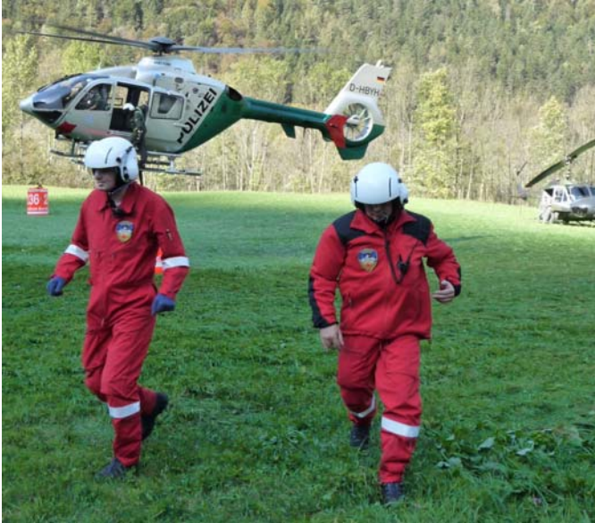
Abb. 6.1.4/4: Für besondere Anwendungen werden spezielle Helme benötigt. Für die Einweisung von Hubschraubern mit ausgebildeten Flughelfern sind Helme mit Aufschaltung von Flugfunk 1 sinnvoll, wie sie nach den österreichischen nun auch von einigen bayerischen Feuerwehren verwendet werden. (Foto: Cimolino)
