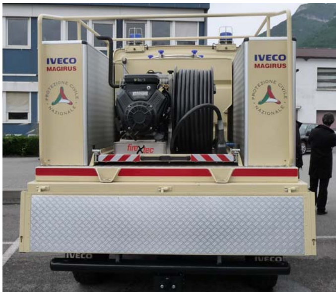
Abb. 6.3.1/15: Für den italienischen Zivilschutz wurden z.B. Iveco SCAM mit Geräte- und Pumpenaufsatz von Camiva aufgebaut und auf dem Waldbrandseminar 2008 Camica/Chambery (F) ausgestellt. (Foto: Cimolino)
