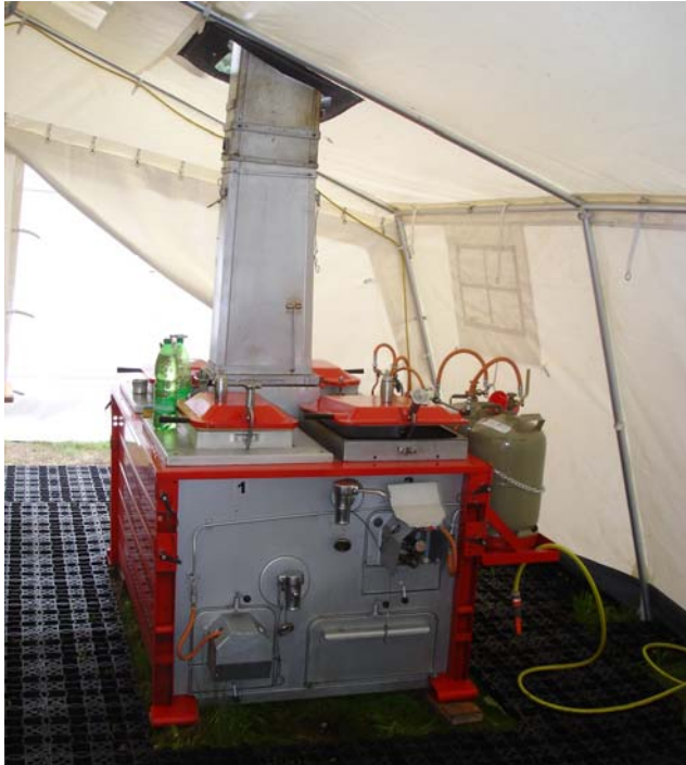
Abb. 7.4/3: Die Versorgung mit Lebensmitteln weit ab von üblichen Strukturen benötigt auch heute noch Feldküchen mit den daran bzw. dafür ausgebildeten Köchen. Hier eine vom Anhänger abgeprozte, d.h. stationär aufgebaute Küche (Feldkochherd), in einem Küchenzelt. (Foto: Cimolino)
