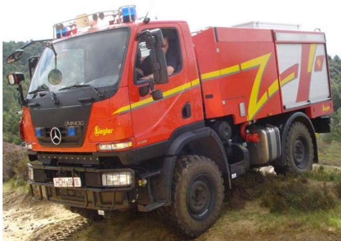
Abb. 6.3.1/8: TLF 2000 gibt es auf Transporter-, mittleren LKW-Fahrgestellen und Unimog (hier auf U 20 1 ). (Foto: Cimolino)
