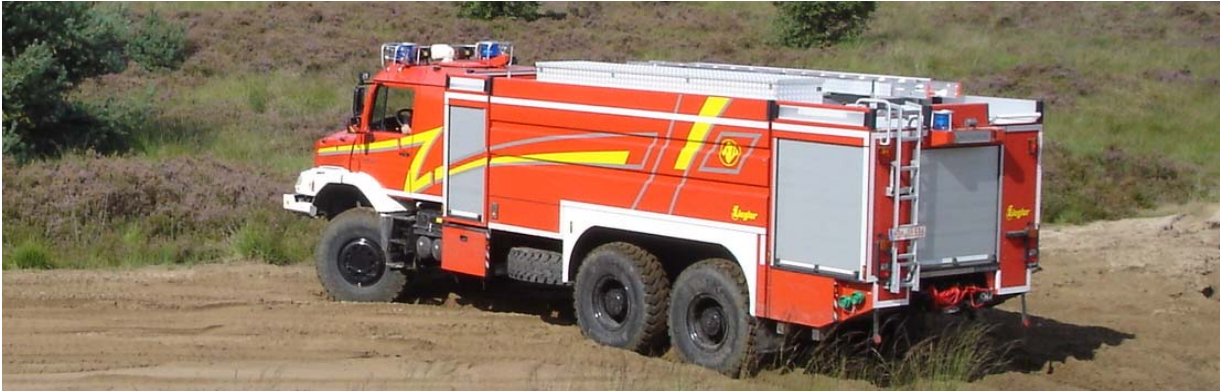
Abb. 6.3.1/11: Auch auf militarisierten bzw. v.a. für das Militär entwickelten Fahrgestellen (hier MB Zetros) werden geländegängige G-TLF aufgebaut. Auf dem Bild ist gut zu sehen, wie groß der Wendekreis eines solchen Fahrzeugs mit 2 nicht gelenkten Hinterachsen ist. (Foto: Cimolino)
