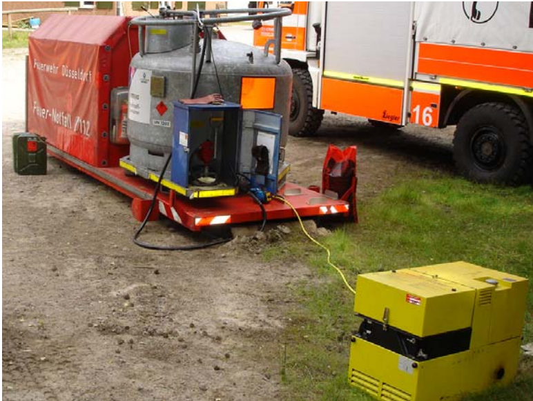
Abb. 7.4/1: Handelsübliche mobile Tankstelle der Fw Düsseldorf (AB Kraftstoff) 1 . Kanister mit verschiedenen Betriebsstoffen befinden sich unter der Plane. Der Stromerzeuger betreibt die elektrische Kraftstoffpumpe. Der Kraftstoff ist aber auch manuell entnehmbar 2 . (Foto: Cimolino)
