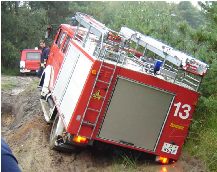
Abb. 5.1.6/6: Zwillingsbereifung ist im schweren Gelände schlechter als spurgleiche Singlebereifung. Sie benötigt im Gegensatz zur Singlebereifung mehr Fahrspuren (6 statt 2) und kann hinten durch eingefahrene größere Steine leichter beschädigt werden. 1 (Foto: Spikowski, Düsseldorf)
