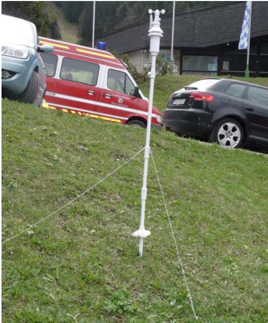
Abb. 7.3.2/3: Mobile Wetterstation der bayerischen Feuerwehren mit Löschwasser-außenlastbehälter. Hier mit abgesetzten Messgeräten unmittelbar neben der fliegerischen Einsatz- bzw. Abschnittsleitung am Feldflug- bzw. -landeplatz. (Foto: Cimolino)
