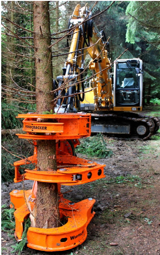
Abb. 7.3.1/1.c: Ähnliche Geräte gibt es auch als Anbauteile für Baumaschinen (hier an einem Raupenbagger). (Fotos: Weber, Schwäbisch-Gmünd)
