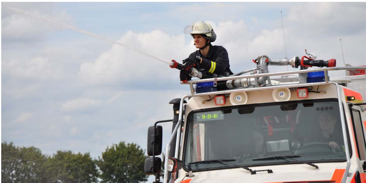
Abb. 7.1.2/9: Kontrollieren und Ablöschen von Verteidigungslinien erfordert Pump&Roll-fähige Fahrzeuge. Zielgerichtetes Einsetzen von handgeführten Rohren vom Fahrzeug verbessert die Einsatzgenauigkeit und reduziert die Verschwendung des i.d.R. knappen Gutes „Löschwasser“. (Foto: Truckenmüller, Düsseldorf)
