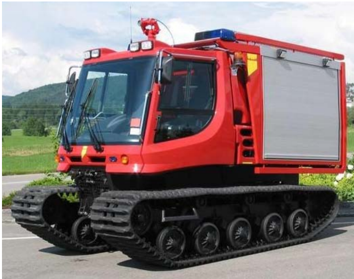
Abb. 6.3.1/24: Der Kässbohrer-Fireflex basiert einer Pistenraupe, hat aber für den Geländeeinsatz geeignetere Ketten. Ähnliche Fahrzeuge werden z.B. von der Bundeswehr in Truppenübungsplätzen bzw. Erprobungsstellen eingesetzt. (Foto: Zawadke, Neu-Ulm)
