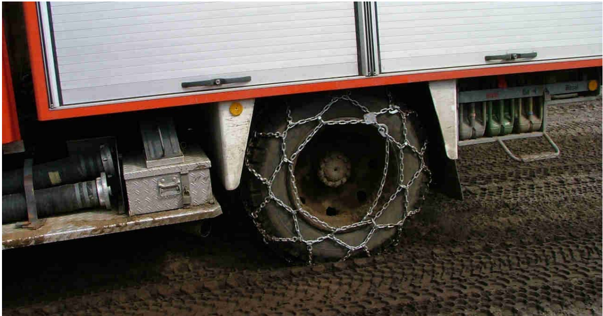
Abb. 6.3.1/22: Gleitschutzketten zur Traktionsverbesserung. (Foto: Spikowski, Düsseldorf)
