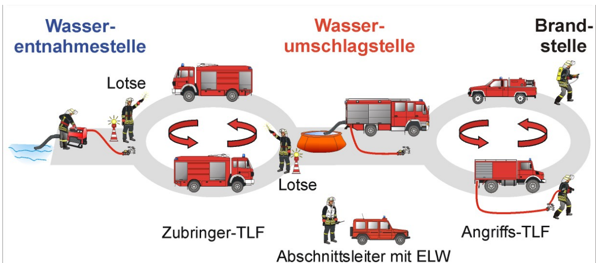
Abb. 7.6/3: Doppelter Pendelverkehr: Ein (i.d.R. größeres TLF) pendelt von einer Wasserentnahmestelle zu einer Wasserübergabestelle und speist dort (direkt oder über einen Zwischenbehälter bzw. Puffer-TLF) andere (i.d.R. kleinere) TLF. Diese(s) pendelt dann weiter vorn zur Brandstelle (vgl. Einfacher Pendelverkehr). (Grafik: Weich, Düsseldorf)
