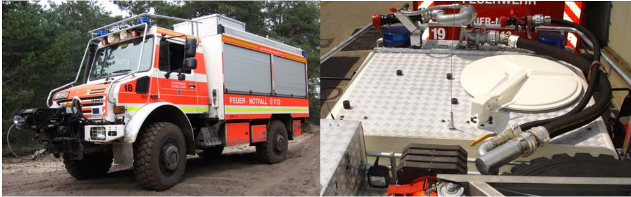
Abb. 6.3.1/7.a und b: TLF 3000-W der Feuerwehr Düsseldorf auf U 5000 mit geschützten Leitungen, Selbstbergungswinde, Reifendruckregelanlage, Ersatzrad, Druckzumischanlage, einen kleinen Dachwerfer bzw. alternativ ein manuell geführtes Rohr bedienbar von der Dachluke über dem Beifahrersitz (vgl. TLF 8-W in Niedersachsen). (Fotos: Cimolino)
