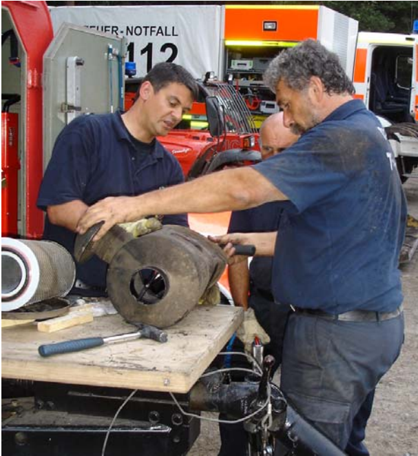
Abb. 7.4/7: Reparatur eines im Gelände beschädigten Luftfilters 1 am Werkstattanhänger 2 der Fw Düsseldorf. (Foto: Cimolino)
