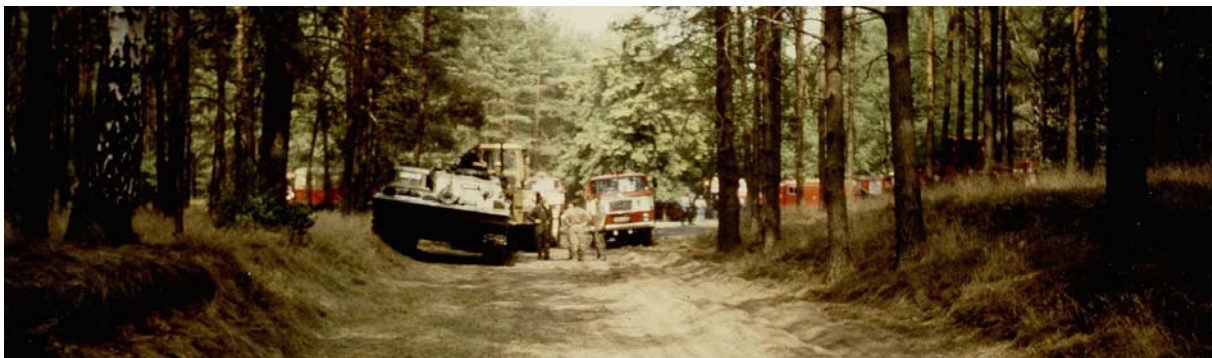
Abb. 7.4/9: Sinken Panzer in schmalen Wegen ein, oder werfen sich die Ketten 1 ab, dann ist der Weg schnell komplett blockiert bzw. wird durch tiefe Spurrinnen für Radfahrzeuge unpassierbar. Dies wurde für die Waldbrände von 1975 mehrfach berichtet, u.a. von ACHILLES, 1976 und PUF, 1975. Hier ein Foto aus den Waldbränden rund um Weißwasser, 1992, das die Dimension von Panzer und Wegen illustriert. (Foto: Hilger, Düsseldorf)
