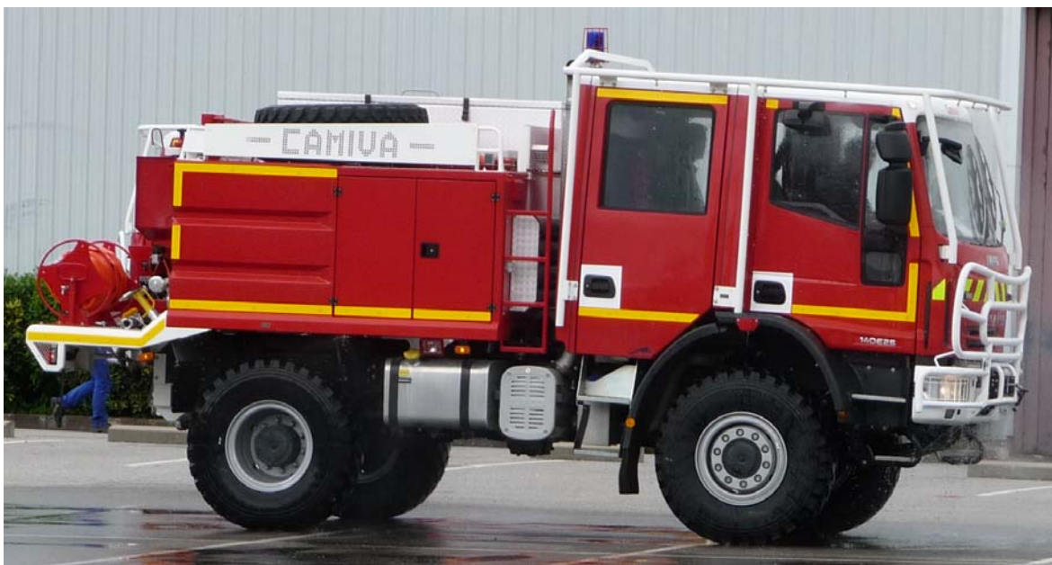
Abb. 6.3.1/4: Schutzdüsen schützen bei französischen Waldbrand-TLF die Kabine mit einem auf diese aufgespritzten Wasserschleier (die Düsen sind daher nach innen gerichtet). Gut zu erkennen sind auch die weiß umrandeten Türgriffe sowie als passiver Schutz ein Rammschutz vor dem Kühlergrill. Das Fahrzeug verfügt darüber hinaus auch noch über geschützte Leitungen, vgl. Abb. 6.3.1/2. (Foto: Cimolino)
