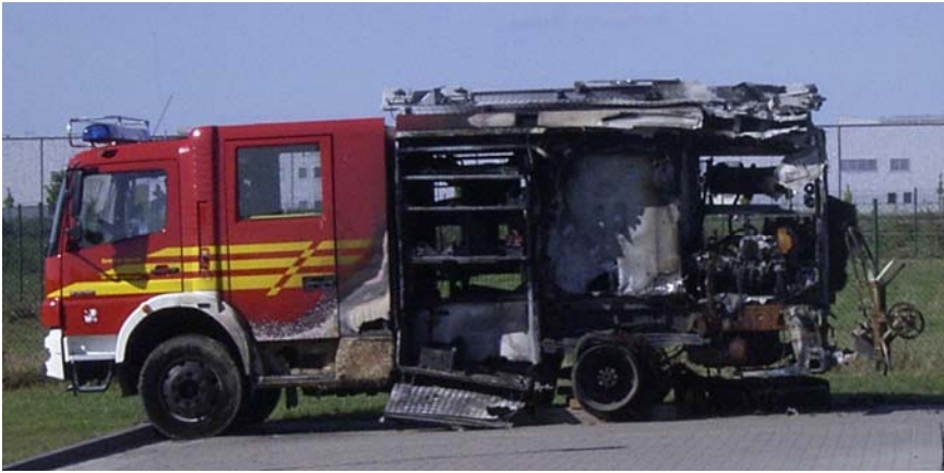
Abb. 5.1.6/4: Vermutlich eine beschädigte Druckluftleitung führte 2008 zum Totalverlust des Fahrzeugs. (Foto: Glockzin, Gröningen)
