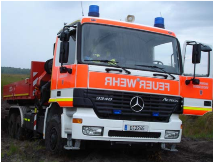
Abb. 6.3.1/12: Das Allrad-Single-WLF hat sich selbst mit leeren AB 1 festgefahren, als der Fahrer auf Sandboden eine enge Kurve zu fahren versuchte. Die eigene Befreiung scheiterte, es musste ein anderes Fahrzeug zu Hilfe kommen. (Foto: Cimolino)
