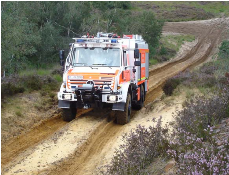
Abb. 6.3/1: Fahren im Gelände ist völlig anders wie das Fahren auf befestigten Straßen. Es muss daher geübt 1 werden: TLF 3000-W der Feuerwehr Düsseldorf im Gelände (Bergfahrt auf weichem Boden). (Foto: Cimolino)
