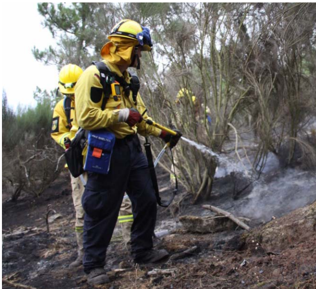
Abb. 6.2/3: Der Einsatz von tragbaren Kleinlöschgeräten, hier Rucksack-spritzen, ist für Nachlöscharbeiten ein sehr effizientes Mittel, wenn die Geräte und das Löschmittel (mit Netzmittel!) richtig eingesetzt werden. (Foto: @fire)
