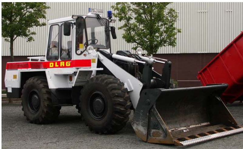
Abb. 6.3.3/19: Wundstreifen benötigen großes Gerät. Dieses kann aus dem Straßen-, Forst- bzw. Landschaftsbau kommen, oder von BOS-Einheiten bzw. der Bundeswehr. Den Leitstellen sollten entsprechende Übersichten vorliegen, hier ein Radlader der DLRG (!). (Foto: Tampier, Dortmund)
