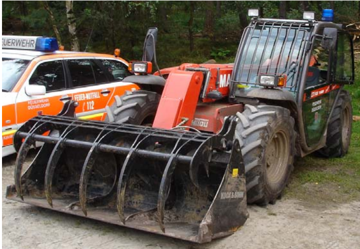
Abb. 6.3.3/18: Teleskoplader (TL) können je nach Größe und Ausrüstung vielfältig verwendet werden. Dieser TL der Fw Düsseldorf verfügt über mehrere Anbaumöglichkeiten 3 und ausgeschäumte 4 Reifen. (Foto: Cimolino)
