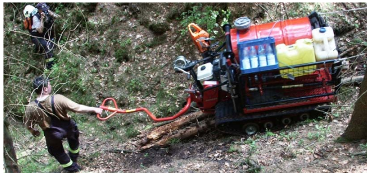
Abb. 6.3.3/12 und 13 1 : Iron Horse als Geräteträger für z.B. TS und Schläuche als Außenlast an einem Hubschrauber beim Transport in unwegsames Gelände – und im Einsatz im schweren Gelände der Sächsischen Schweiz zur Vegetationsbrandbekämpfung. (Fotos: Kögler, Ottendorf)
