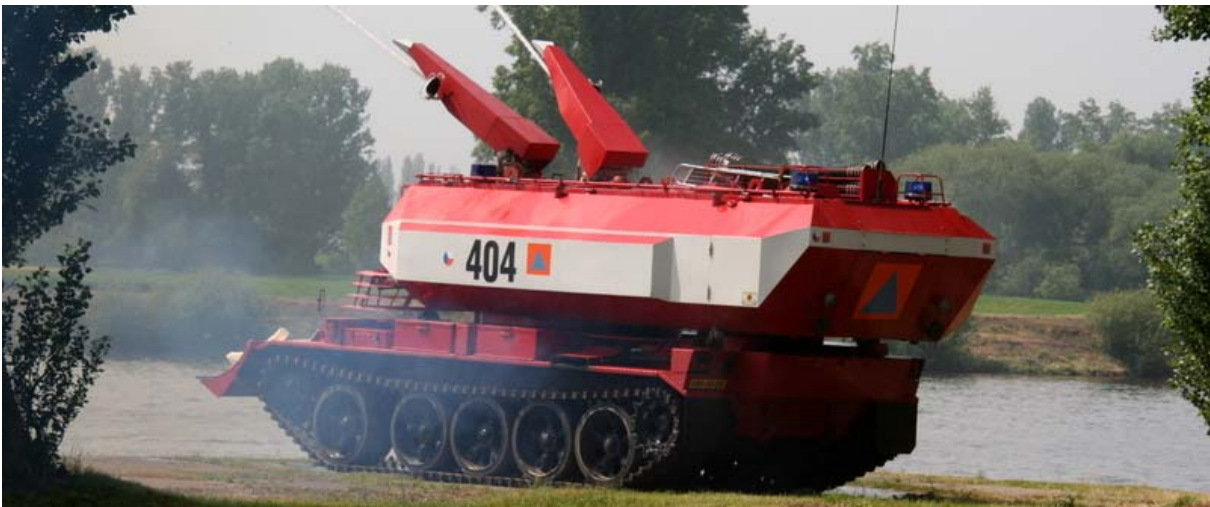
Abb. 6.3.1/19: Tschechischer Löschpanzer auf russischem T 55-Fahrgestell 1 mit Räumschild und weiteren Löschdüsen an der Vorderseite des Fahrzeugs. Nach BOS-FAHRZEUGE, 2013 wurden davon 32 Stück gebaut und die Hälfte exportiert 2 . (Foto: Kögler, Ottendorf)
