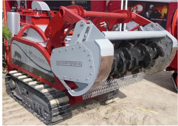
Abb. 6.3.3/8.a und b: Ähnlich ausgerüstete und für den Vegetationsbrand spezialisierte Fahrzeuge gibt es mittlerweile auch in Europa. Hier zwei Modelle unterschiedlicher Größe, ausgestellt auf der Interschutz 2010 in Leipzig. Ähnliche Effekte kann man auch mit Minenräumpanzern (z.B. MRPz Keiler) erzielen! (Fotos: Cimolino)
