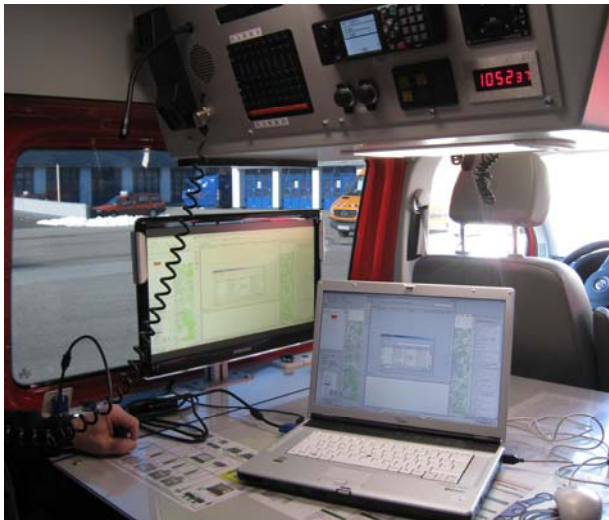
Abb. 7.2/1: Stabsunterstützungssystem (hier: metropoly BOS der Fa. Geobyte) im ELW 1 der Feuerwehr Essen. (Foto: Kalthöner, Essen)
