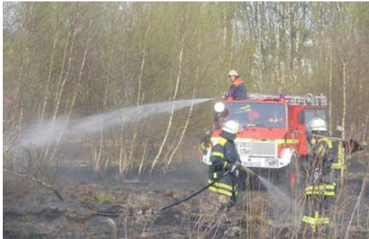
Abb. 5.1.6/1: Geländegängige TLF 8-„W“ auf Unimog 1300 wurden v.a. in Niedersachsen von Ende der 1970er bis in die 1980er beschafft, werden altersbedingt immer seltener. (Foto: Südmersen, Osnabrück)
