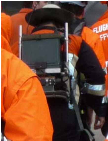
Abb. 6.3/3: Das Tragen von Lasten wird mit einer „Kraxen“ (Rückentrage) erheblich erleichtert und lässt die Hände für Sicherungsarbeiten frei, vgl. Abb. 6.1.6/5-7. Hier zur Funkverbindung von abgesetzten Einheiten zu Fahrzeugen bzw. zur Einsatzleitung eine ältere Rückentrage mit einem FuG 7b inkl. Batterie bei einer Übung in Bayern im Jahr 2010. Entsprechende Halterungen bzw. Ladungssicherungsmöglichkeiten in den Fahrzeugen sind ggf. notwendig. (Foto: Cimolino)
