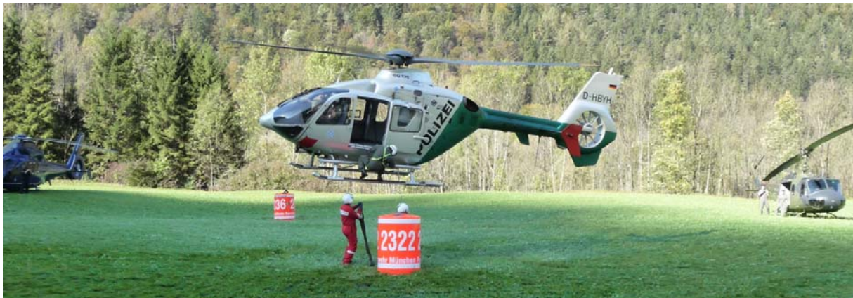
Abb. 5.8.1/2: Zwei Flughelfer unterstützen hier am Boden beim Üben des Einhängens verschiedener Typen von Löschwasser-Außenlastbehältern in verschiedene Hubschraubermuster (abgebildet 3 unterschiedliche Typen). Die Kommunikation der Helfer am Boden zu den Luftfahrzeugführern und zur fliegerischen Leitung am Landeplatz erfolgt über Flugfunk mit Hilfe entsprechender Kommunikationstechnik auch in den Helmen. (Foto: Cimolino)
