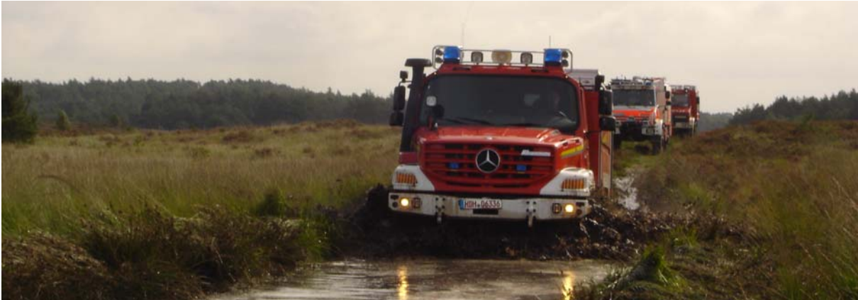
Abb. 5.1.6/8: MB Zetros und MB Unimog U 5000 im Vergleich zu einem alten U 1300 beim Üben einer Wasserdurchfahrt in einer Heidefläche 1 . (Foto: Cimolino)
