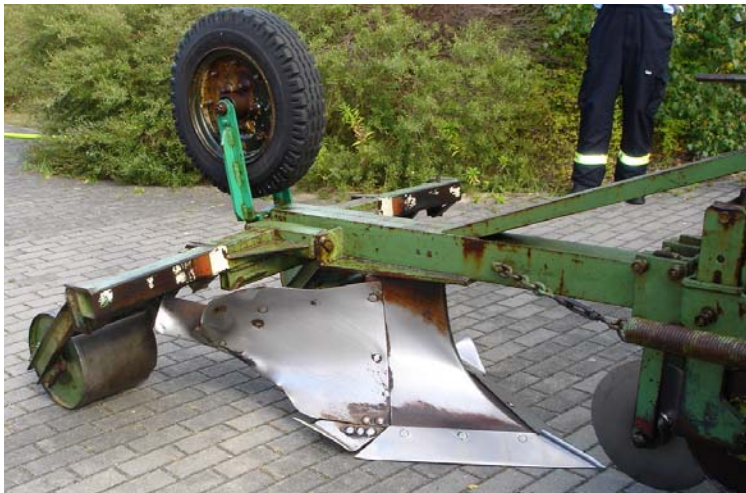
Abb. 7.3.1/2.a-b: Spezieller Waldbrandpflug zum schnellen Erzeugen von Wundstreifen in v.a. sandigen Böden 1 . Der Boden wird mitsamt Wurzelwerk vorgeschritten, aufgebrochen, umgeworfen und festgedrückt. Entwickelt und gebaut wurde er in der ehemaligen DDR. Hier an einem modernen, leistungsfähigen Allrad-Traktor mit Frontlader für Baumstämme, ausgestellt bei der @fire-Fachtagung Wipfelfeuer 2009 in Götz (Havel). Die erreichbare Breite reicht natürlich so allein niemals für ein Feuer aus, ggf. muss mehrfach eine Linie abgefahren und diese auch mit Mannschaft und Gerät verteidigt werden. (Fotos: Cimolino)
