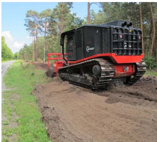
Abb. 6.3.3/9.a – c: Mittlerweile gibt es auch in der Forstwirtschaft immer größere dieser Spezialfahrzeuge entweder als „Biomasse-Harvester“ (a und b), bei denen mit LKW der organische Bestandteil direkt abgefahren werden kann; oder Mulcher (c), die Schneisen in auch dichterem Bewuchs schlagen und den Boden direkt mit umfräsen können. (Foto: Lutz, Hohentegen, Fa. Prinoth 1 , Sterzing (Italien))
