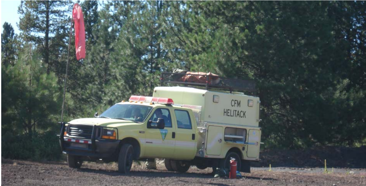
Abb. 6.3.3/6: Fahrzeug zum Nachführen spezieller Ausrüstung einer Hubschrauber-Löschmannschaft „HeliTac-Crew“ bzw. für die Unterstützung der Hubschrauberbesatzungen bei Außenlandungen oder zur Orientierung im Schadensgebiet (daher der große farbige Windsack). (Für die Einrichtung und das Betreiben von Hubschrauberlandeplätzen werden seit einiger Zeit z.B. auch in Österreich entsprechende Fahrzeuge beschafft.) (Foto: @fire)
