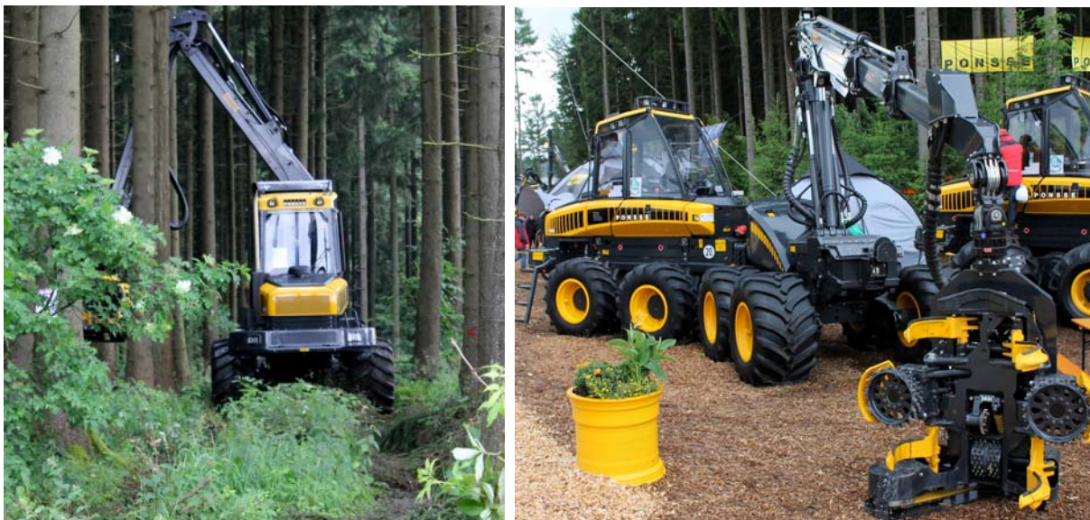
Abb. 7.3.1/1.a - b: Holzvollernter sind aufgrund des Einsatzgebietes mitten im Wald immer voll geländegängig. Es gibt sie als komplette Spezialfahrzeuge (a und b) bzw. Anbauteile (vgl. c auf der Folgeseite).
