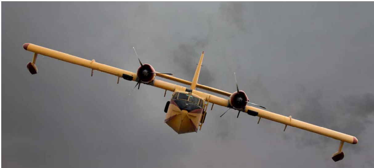
Abb. 7.7/1.a: Scooper sind Wasserflugzeuge. Sie nehmen in einer Teilwasserung im Flug auf geeigneten Gewässern über Öffnungen im Rumpf Wasser auf. Sie verfügen daher über einen bootsartigen Rumpf und Schwimmkörper. (Foto: Weber, Schwäbisch-Gmünd)
