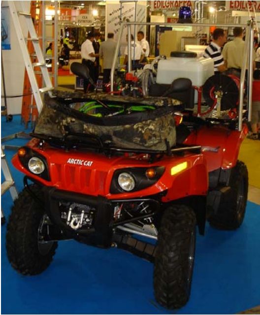
Abb. 6.3.3/2: Selbst Quads gibt es mit kleineren Löschanlagen 1 (heller Kunststofftank auf dem Heckgepäckträger). Diese können ggf. Einsatzkräfte auch in schwierigem Gelände unterstützen. Es ist allerdings zu bedenken, dass die transportierten Löschmittelmengen eher gering im Verhältnis zum Fahrzeuggewicht sind und dass sich i.d.R. die Gewichtsverteilung für den Einsatz im Gelände sehr ungünstig verändert. (Foto: Cimolino)
