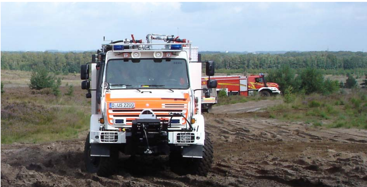
Abb. 6.3.1/21: Fahrzeuge wie der Unimog U 5000 oder der Zetros (Bildhintergrund) oder ähnliche verfügen über die Möglichkeit, den Reifendruck auch während der Fahrt nach unten oder oben zu verändern. Sie sind damit prädestiniert, für den Einsatz in schwerem Gelände, v.a. auch auf sandigen Böden. (Foto: Cimolino)
