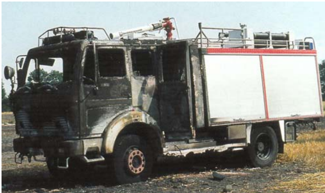
Abb. 6.3.1/1: Vermutlich eine durchgeschmorte Bremsleitung führte 1992 beim Stoppelfeldbrand an diesem TLF 16/25 der BF Hamburg zum Zwangshalt (ausgelöster Federspeicher) und danach zu erheblichen Brandschäden. (Foto: Gihl, Hamburg)
