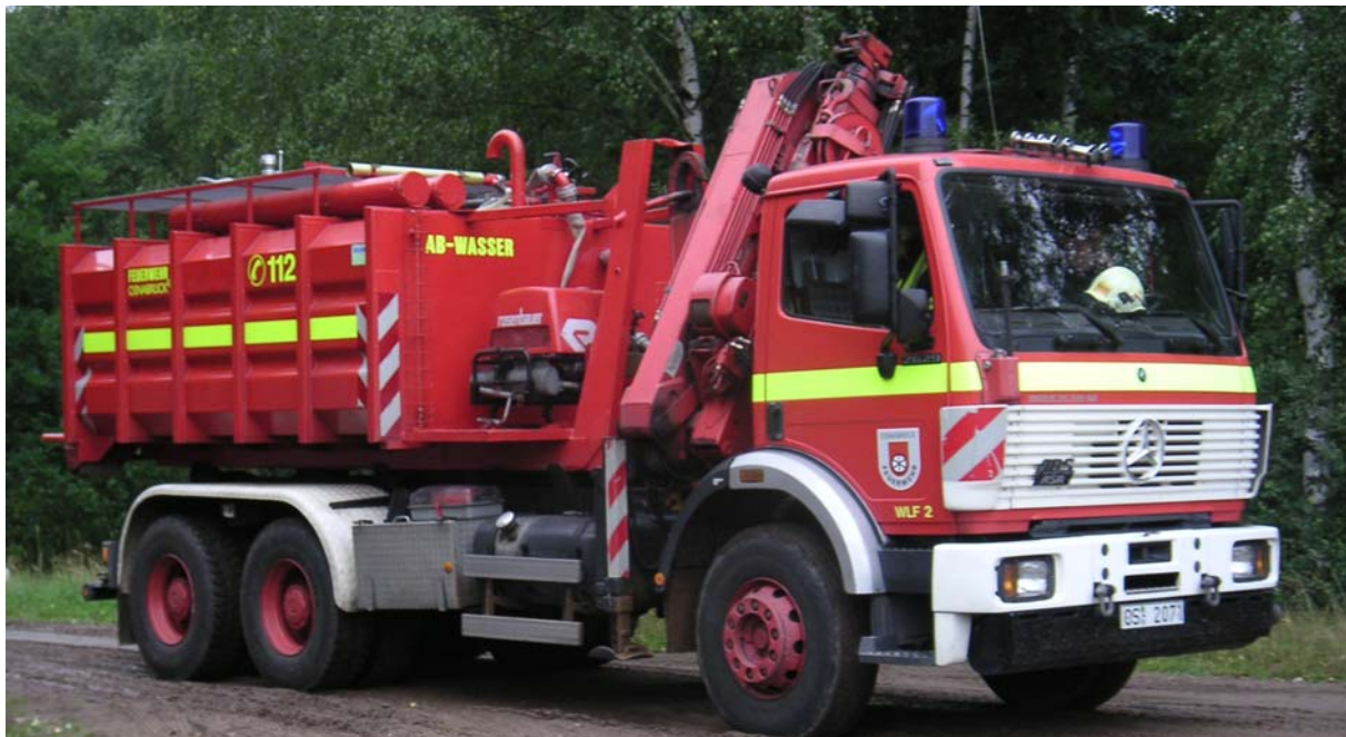
Abb. 6.3.1/13: Hier ein WLF mit AB Tank der Feuerwehr Osnabrück bei einer Waldbrandübung, die einmal mehr bestätigte, dass derartige Fahrzeuge auf engen und nur eingeschränkt tragfähigen Wegen Probleme bekommen. (Foto: Dr. de Vries, Hamburg)
