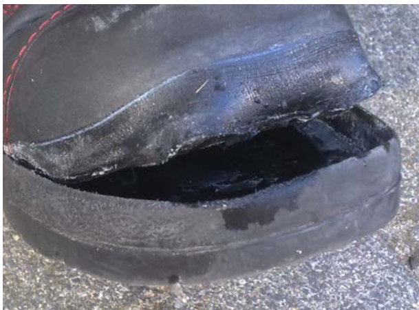
Abb. 6.1.5/1: Da man sich teilweise länger in verbrannten Bereichen mit heißen Böden bzw. Glutnestern aufhalten muss, ist darauf zu achten, dass die Sohle hitzebeständig und ausreichend befestigt ist. (Foto: Südmersen, Osnabrück)
