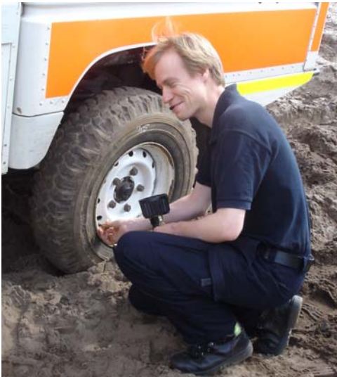
Abb. 6.3.1/20: Manuelles Absenken des Luftdrucks zur Vergrößerung der Reifenfläche, um den Bodendruck zu reduzieren und die Traktion zu erhöhen. Dazu muss man wissen, wie weit der Luftdruck gesenkt werden darf, damit es nicht zu Schäden am Reifen oder zum Durchdrehen auf der Felge kommt 1 . Dafür benötigt man auch ein geeignetes Reifendruckmessgerät - und vor dem Befahren von Straßen wieder eine Füllmöglichkeit. (Foto: Cimolino)
