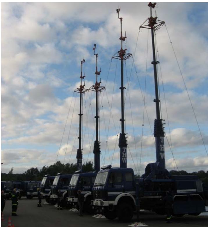
Abb. 7.2.3/2: Das THW hält einige wenige spezialisierte Einheiten vor. Diese verfügen über insgesamt 5 sog. Mast-Kraftwagen (ehemals Bundeswehr). Mit diesen können auch sonst schlecht erschlossene Gebiete mobil versorgt werden. (Foto: THW Arnsberg)
