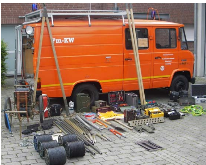
Abb. 7.2.3/3: Gerätewagen mit Ausstattung zum Feldkabelbau. (Foto: THW Arnsberg)
