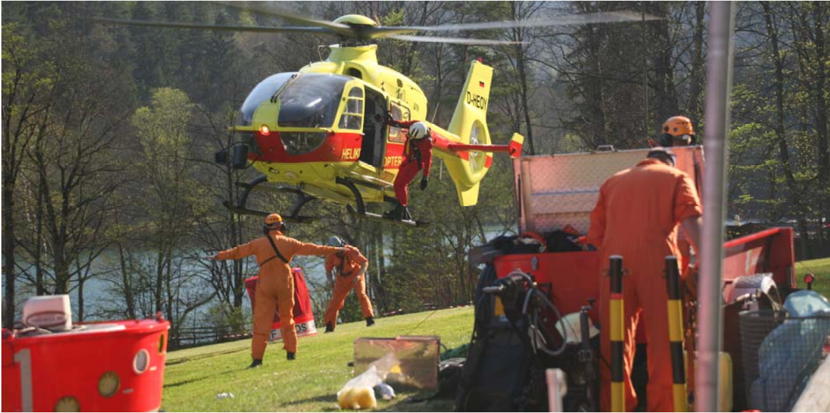
Abb. 7.3.4/1: Flughelfer am Behelfslandeplatz. Einer weist den Piloten ein, der andere hängt die Außenlast ein, andere bereiten die nächsten Aufträge vor. (Foto: FF Bad Reichenhall)
