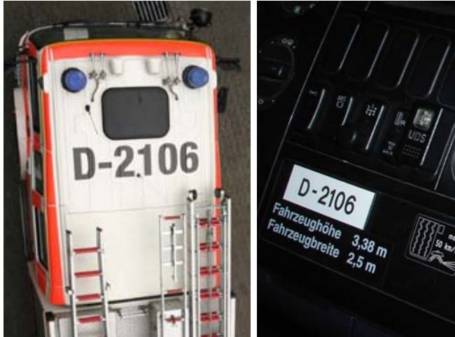
Abb. 5.1.4/1 und 2: Dachkennzeichnung zur Ansprache der Einsatzfahrzeuge aus der Luft. Sie zeigt nach DIN 14035 das KFZ-Kennzeichen. Dies muss auch im Fahrzeug bekannt sein, weil sonst die Einsatzkräfte darin ggf. nicht wissen, dass sie gemeint sind 3 . (Fotos: Truckenmüller, Düsseldorf; Cimolino)
