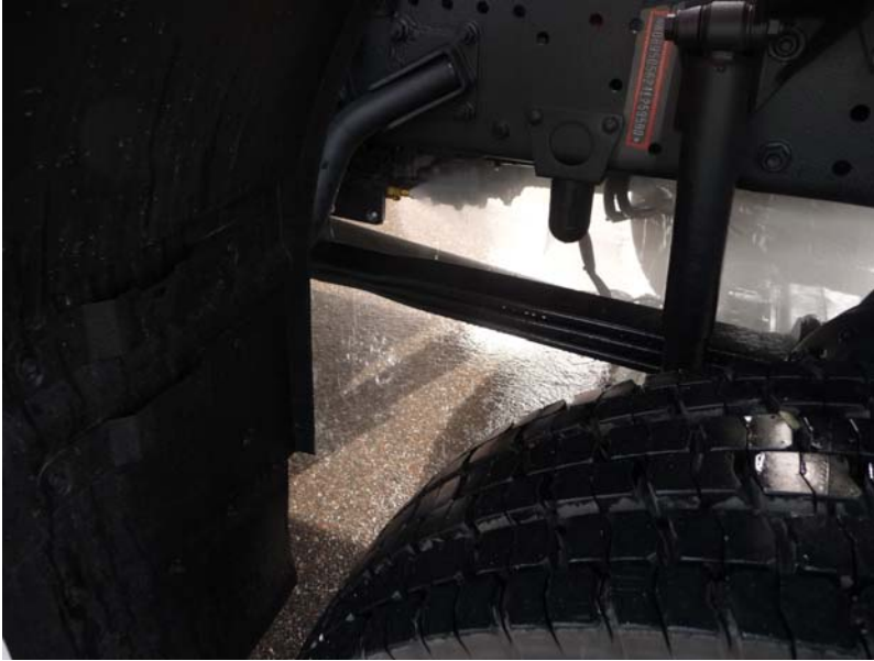
Abb. 6.3.1/5: Auch Fahrgestellkomponenten wie hier an einem PTLF 4000 (TLF 20/40-SL) der Feuerwehr Düsseldorf können mit Schutzdüsen (Pfeil) auf wichtige Fahrgestellkomponenten geschützt werden. (Foto: Cimolino)
