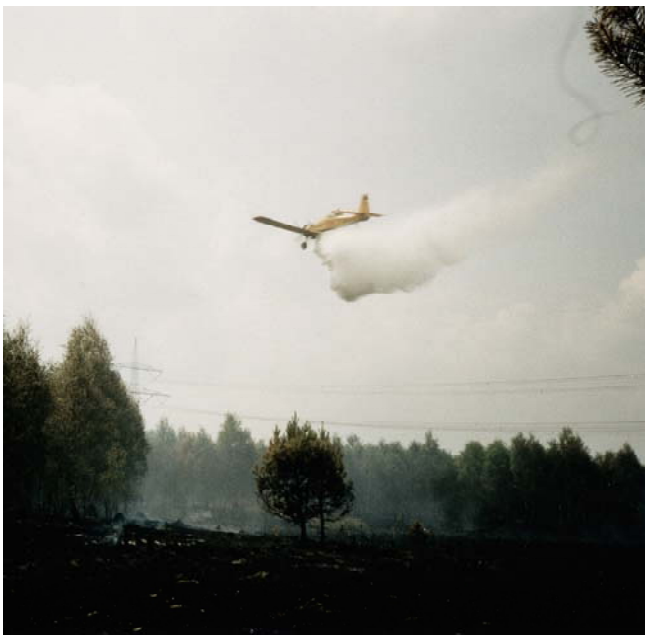
Abb. 7.7/2: Kleinere Flächenflugzeuge können flexibler und schneller eingesetzt werden, als größere Flugzeuge (z.B. Transall), die eine umfangreiche Infrastruktur benötigen. Die transportierte Löschwassermenge dieser „Agrarflieger“ ist aber relativ gering. Ein Punktwurf ist im Gegensatz zum Hubschrauber nicht möglich. Hier: Agrarflugzeug im Einsatz, 1992 um Weißwasser 1 . (Foto: Hilger, Düsseldorf)
