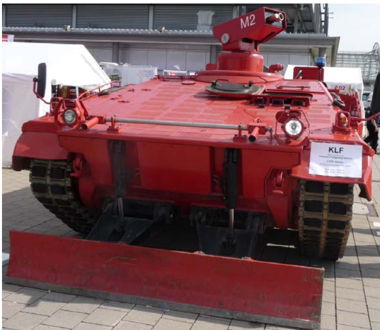
Abb. 6.3.1/17: Hier ein Fahrzeug der Fa. Airmatic 3 auf Basis des Marders mit Räumschild, das damit auch eingeschränkt zum Räumen von Schneisen eingesetzt werden kann. Es hat eine zGM von ca. 35 t. (Foto: Cimolino)
