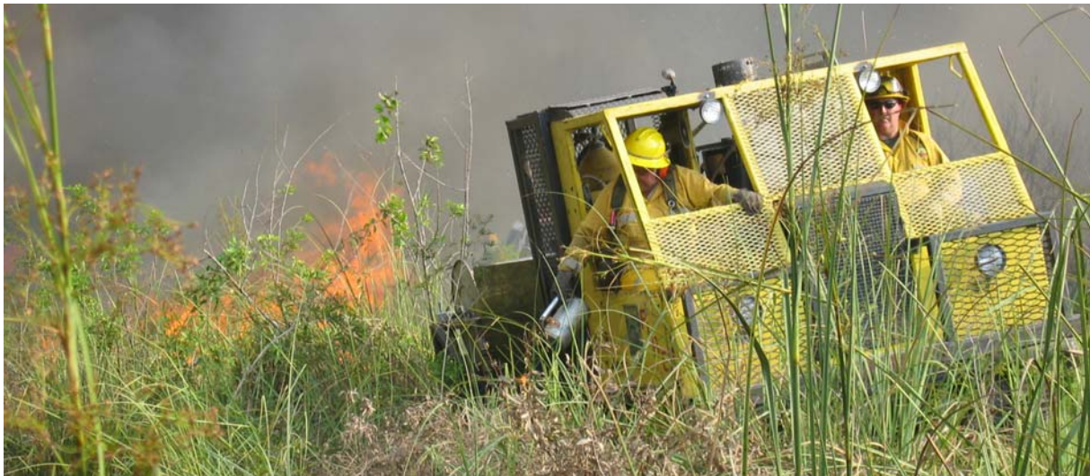
Abb. 6.3.1/23: Kettenfahrzeug in den USA für Personal- bzw. Materialtransport. Hier in der Sonderanwendung „fahrbare Drip Torch“, vgl. Kap. 7.1.2. (Foto: Südmersen, Osnabrück)
