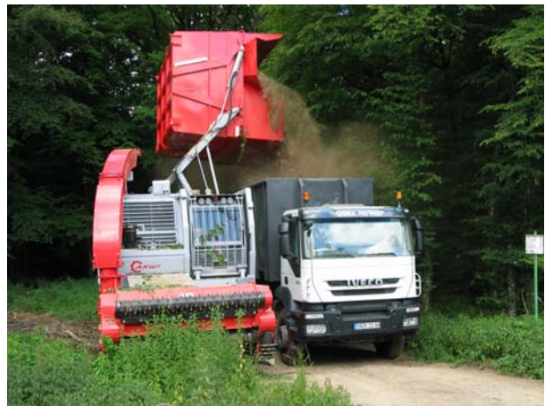
Abb. 6.3.3/9.a – c: Mittlerweile gibt es auch in der Forstwirtschaft immer größere dieser Spezialfahrzeuge entweder als „Biomasse-Harvester“ (a und b), bei denen mit LKW der organische Bestandteil direkt abgefahren werden kann; oder Mulcher (c), die Schneisen in auch dichterem Bewuchs schlagen und den Boden direkt mit umfräsen können. (Foto: Lutz, Hohentegen, Fa. Prinoth 1 , Sterzing (Italien))
