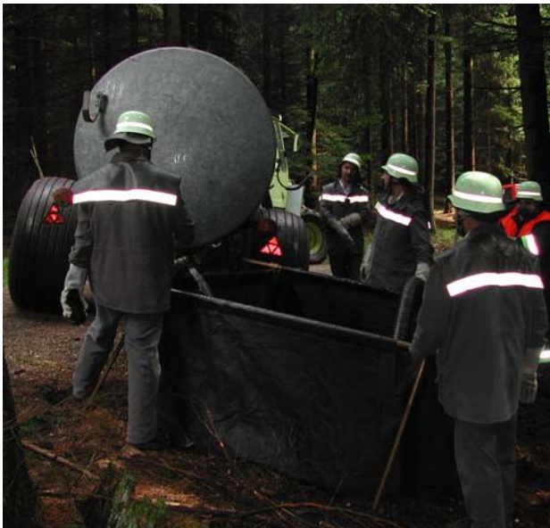
Abb. 6.3.3/17: Das Wasser aus Güllefässern muss in Auffangbehälter o.ä. umgefüllt werden. Aus diesen muss es mit Saugschläuchen mit Saugkorb und Drahtsieb entnommen werden, um eine Verschmutzung der Pumpeneingänge bzw. Schäden 1 in den Pumpen zu vermeiden. Dieses Wasser enthält Fäkalienreste, d.h. Vorsicht mit Wunden und Inkorporation (Atmung). (Foto: Feuerwehr Riedenburg)
