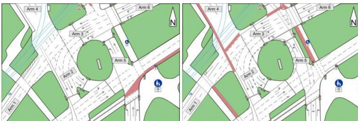
Abbildung 109: Knotenpunkt 6 – Situation vor Änderung (Bild links) und nach Änderung (Bild rechts) (Zeichnung: Biernacki / Seipel)
