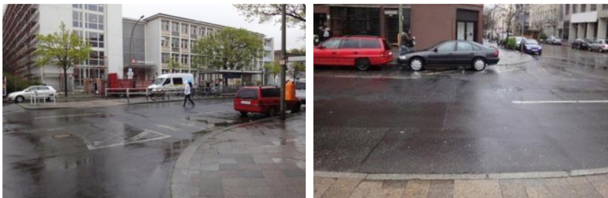
Abbildung 156: Knotenpunkt 14 – Schlechte Erkennbarkeit / keine Schutzfunktion der Aufstellfläche (Bild links) und zugeparkte Aufstellfläche an der Überquerungsstelle 2a (Bild rechts) (Foto: Seipel)
