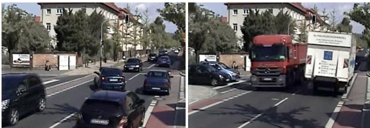
Abbildung 54: Knotenpunkt 10 – Links abbiegende und ausscherende Fahrzeuge (Bild links) und Begegnungsfall Lkw-Lkw (Bild rechts) (Gerlach et al. in Druck)
