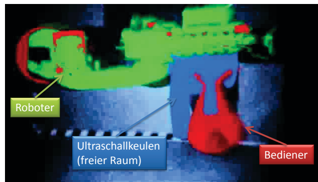
Abbildung 33: Einbindung der geometrischen Form der Ultraschallkeulen in das in [153] entwickelte Programm
