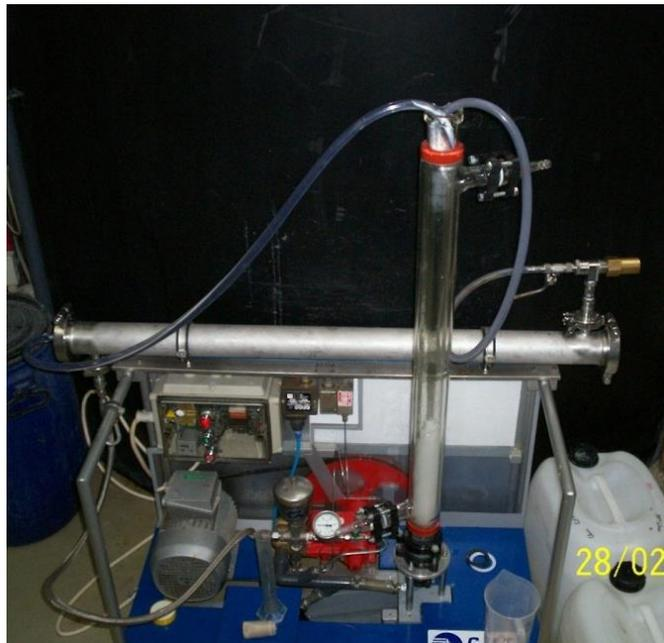
Abbildung 80: Nanofiltrationsanlage zur weitergehenden Reinigung des Eluates (Hersteller CUT Membrane GmbH, Erkrath).
