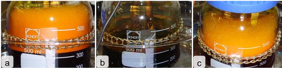
Abbildung 89: Die Fotos sollen das Schaumausmaß der untersuchten Tenside im Chromelektrolyten verdeutlichen: a) Oleylaminethoxylat nach dem Start, b) Oleylaminethoxylat nach 30 h Reaktionszeit und c) PFOS nach 30 h.
