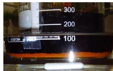
**Abbildung 43: Sedimentbildung beim Kontrollexperiment (ohne Netzmittel) nach 30 h Reaktionszeit.**
