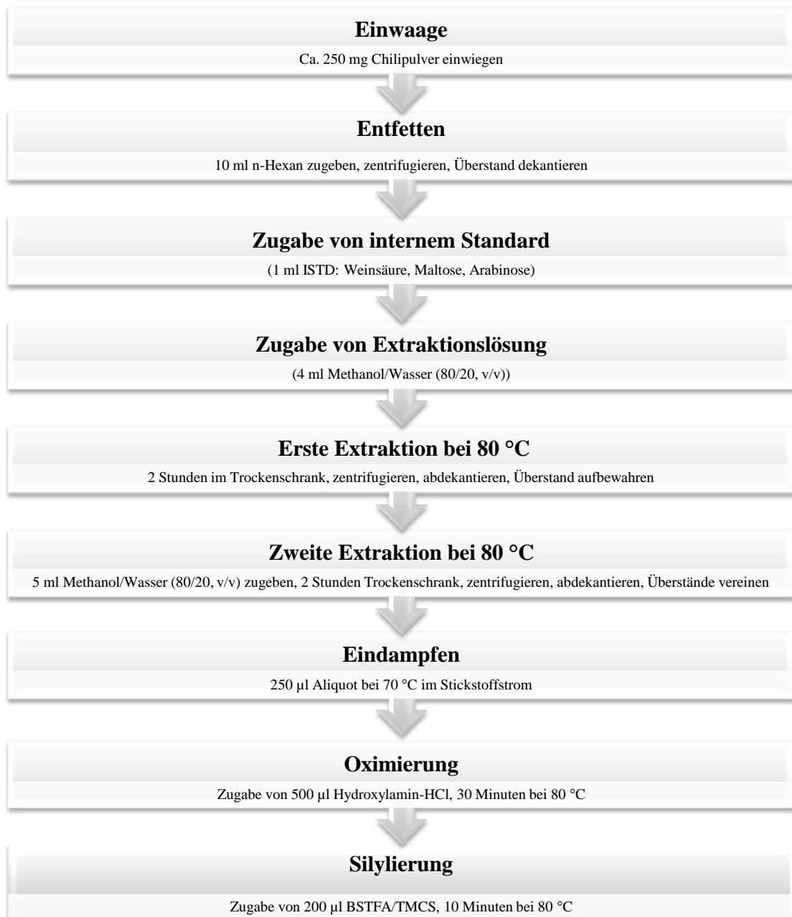
Abbildung 18: Arbeitsschritte zur simultanen Bestimmung von Zuckern und Säuren aus Capsicum -Pulvern
